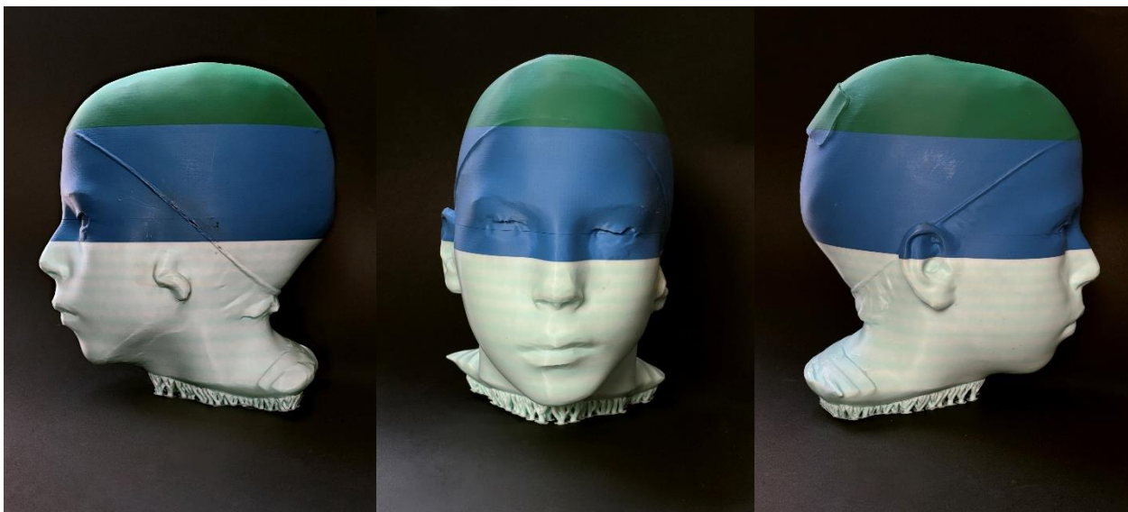
Joonis 4.4. PLA- filamendist 3D-prinditud mudelid, mis on sektorite kaupa trükitud kolmes erinevas värvitoonis asümmeetria määramiseks. Autor: Liina Kinks
