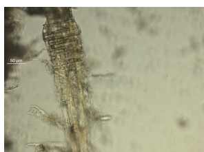
Joonis 8. Tselluloosikiud 200x suurendusega tavalises valguses. Autori erakogu
