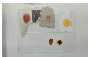
Joonis 9. Floroglütsiini test, tekstita paber (vasakul) ja tekstiga paber (paremal). Autori erakogu
