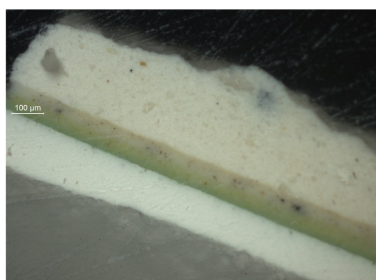
(a) Pealmiste kihtide mikrolihv. Roheline ja valge värv ning pahtel (b) Pahtlialuste kihtide mikrolihv. Pahtel, valge, pruun/hall ja valge värv
