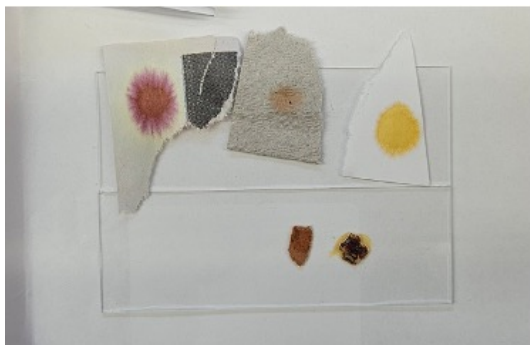
Joonis 15. Floroglütsiini test, tekstita paber (vasakul) ja tekstiga paber (paremal). Autori erakogu
