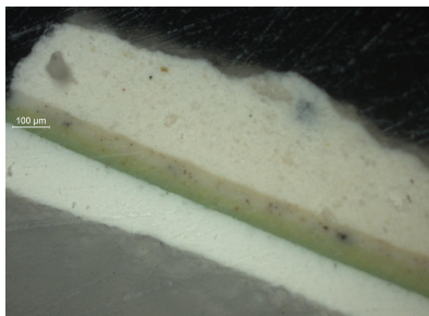
Joonis 3. Pealmiste kihtide mikrolihv. Roheline ja valge värv ning pahtel. Autori erakogu
