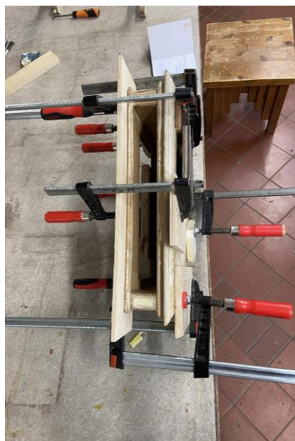
Foto 10. Lauaplaadi ja korpuse kokku liimimine
