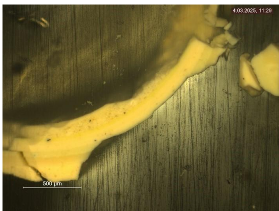
Foto 8. Makrofoto värvikihtidest (erakogu L. K. Sapas) Foto 9. Makrofoto lehthõbeda jääk (erakogu L. K. Sapas)
