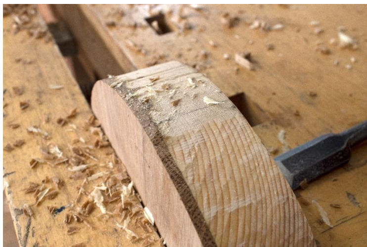
Joonis 34: Tasandamine ja peitli jälgede tegemine
