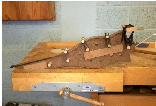
Joonis 28: Painutatud külgede kinnitamine vormile
