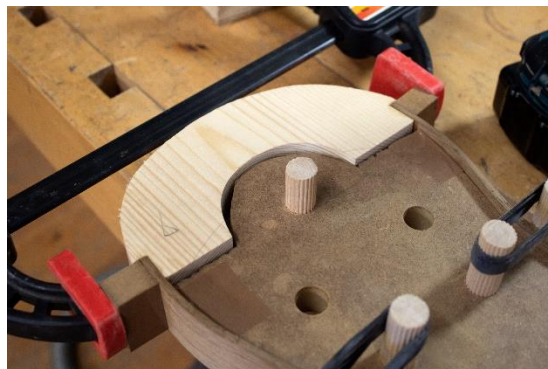
Joonis 30: Otsaklotsi liimimine
