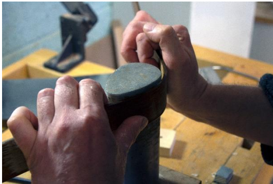
Joonis 27: Kuumarauga painutamine
