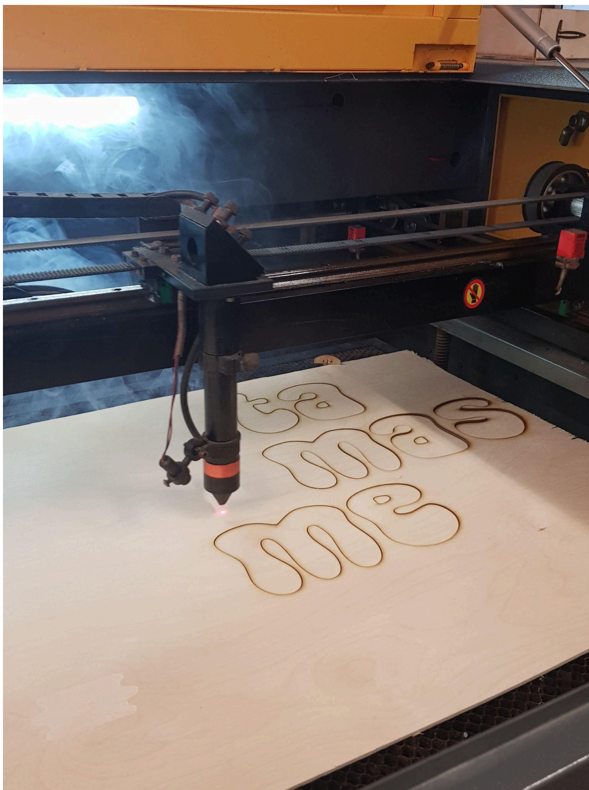
Näitusesaali mineva pealkirja vineerist laseriga välja lõikamine, 2025. Foto: Autor
