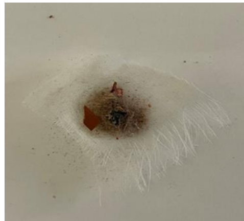
Foto 22 Filtrina kasutatud kangatükk; Foto 23 Filtrisse jäänud mustus, osakesed ja kiud.
