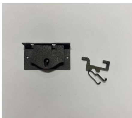
Foto: 35 Lukukorpuse puhastamise käigus eemaldus korpuse seest lehtmetsalli tükk.
