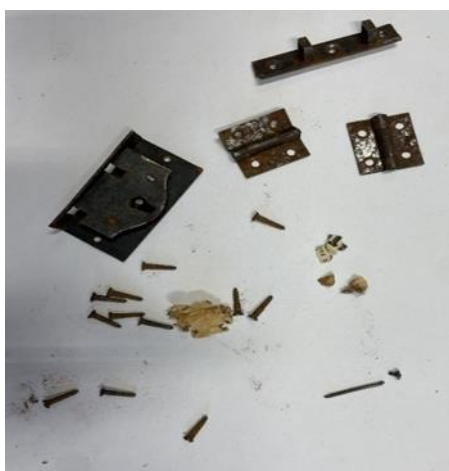
Foto: 33 Metallist lukukorpus, selle vastus ning kaant ja korpust ühendavad kaks lehtmetailist hingemehhanismi koos neid kinnitanud 13. kruviga; Foto 34 Lukukorpusest leitud paberitükid.
