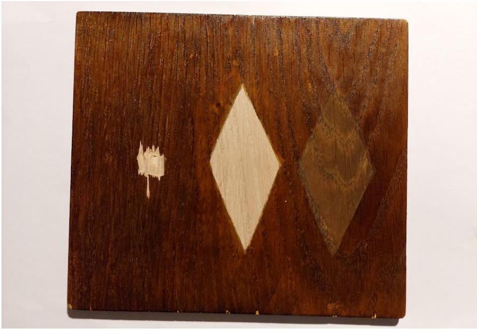
Joonis 6. Tööplaat spooniparanduse tegemiseks
