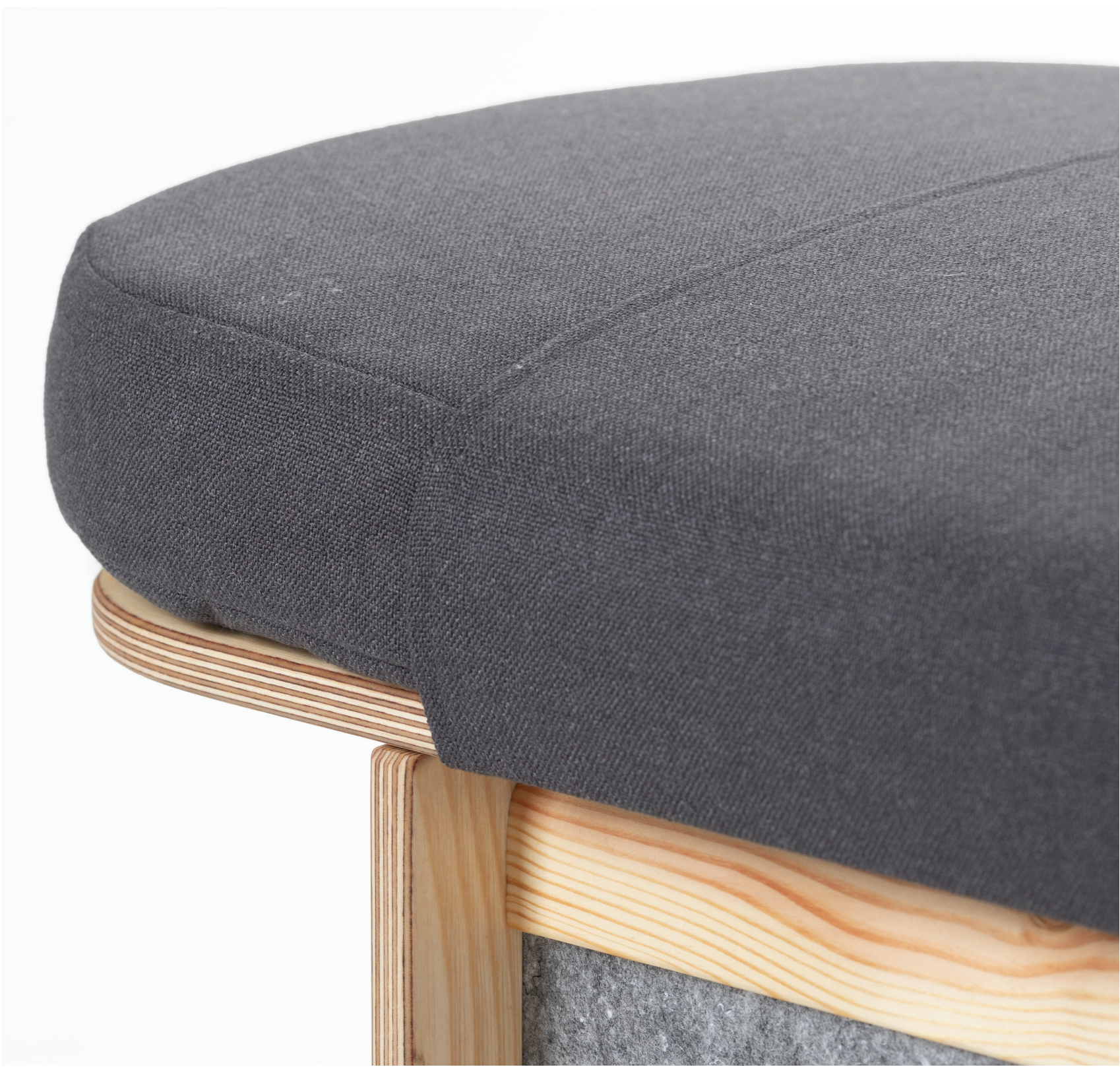
Polsterdus on fikseeritud istmeplaadi ümber pingutatud mööbliriidega. Viltplaatide kinnitamiseks on puitdetailidesse freesitud sooned.
