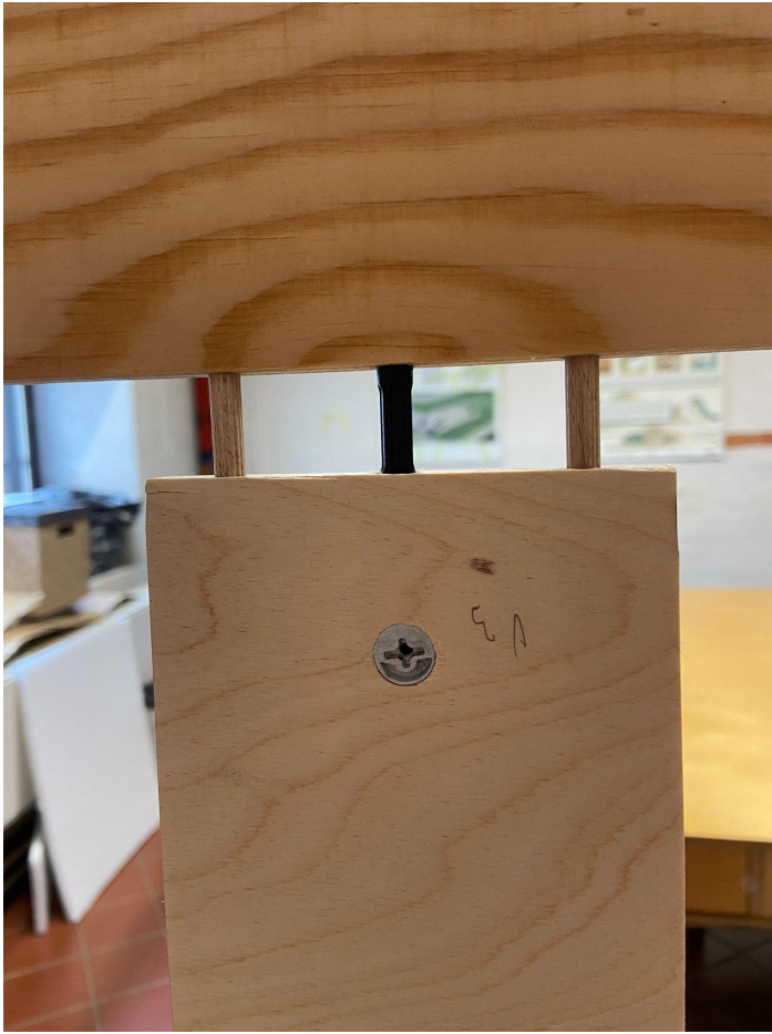
Foto 35. Voodipeatsi detailide ühendamine Minifix tõmmitsa abil
