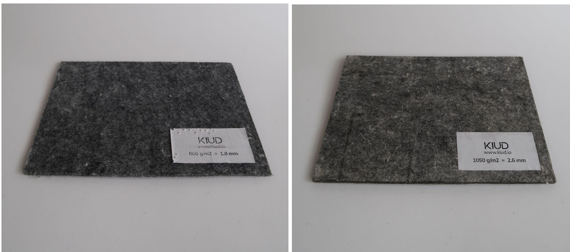
Fotod 29-30. Termomehaaniliselt töödeldud vilt paksusega 1.8mm ja 2.6mm
