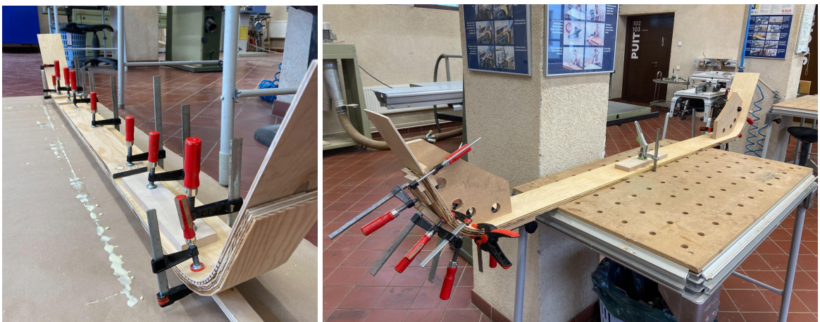
Fotod 33-34. Detaili sisekülje liimimine
