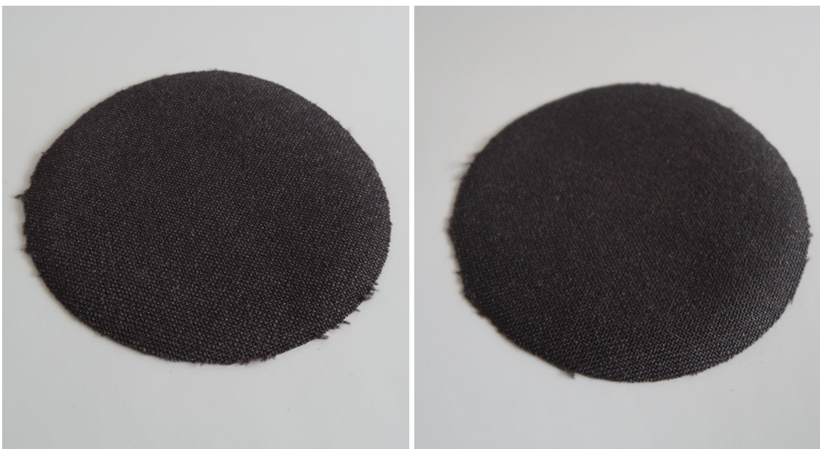
Fotod 27-28. Mööbliriide pillingutesti tulemus peale 500 ja 2000 tsükli
