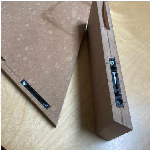
Joonis 3.5. Lamello Clamex P-14 katsetamine proovimaterjali peal. Autor: Märt-Kaarel Petser
