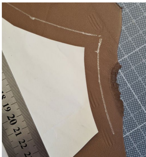
Foto 31. Õmblusvaru sisse jäetud defekt ja juurdelõikus ketasnoaga
