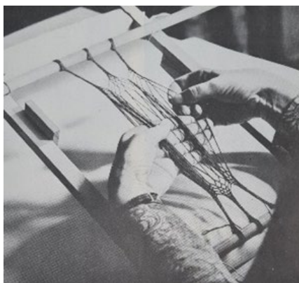
Foto 11. Võrkvöö raam ja vertikaalsete lõimede punumine (Bohne-Fiebert, 1986)
