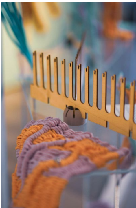
Foto 13. MultiWeave tehnikas kudumiseks kasutatav raam koos hoidikuga. Foto: Lisette Laanoja
