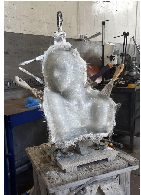
Joonis 5. Vormi lahtivõtmine pahtlilabidatega
