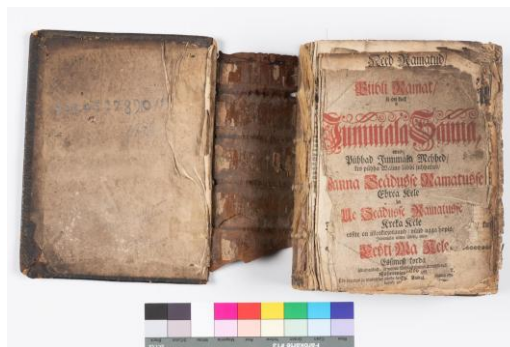
Foto 4. Esikaas oli plokist eraldunud, tiitellehel olid suured paberikaod (foto Berta Jänes)
