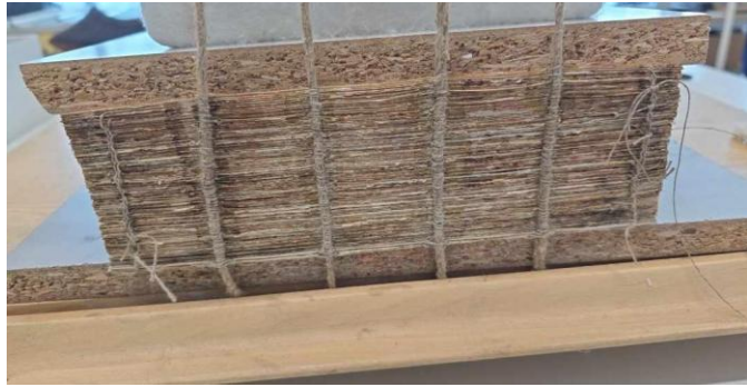
Foto 10. Piibel köideti köitmisraamil nelja köitmenööri kolm poognat korraga (Autori foto)
