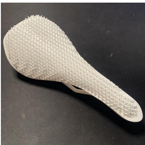
Pilt 3.1.1.4 SLS prinditud detail. Autor Carl-Eric Uibo
