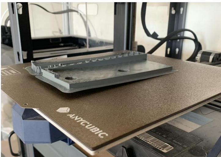
Pilt 3.1.3.4 Detail eraldub ehitusplaadilt, jahtumisel jahedas keskkonnas. Autor Carl-Eric Uibo
