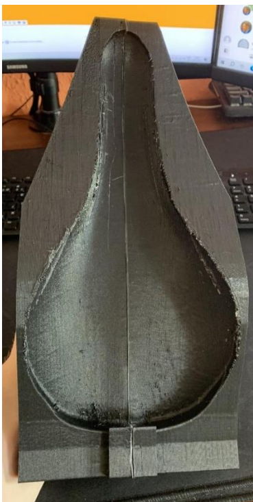
Pilt 3.1.3.3 Kinnitatud vormi pooled. Autor Carl-Eric Uibo
