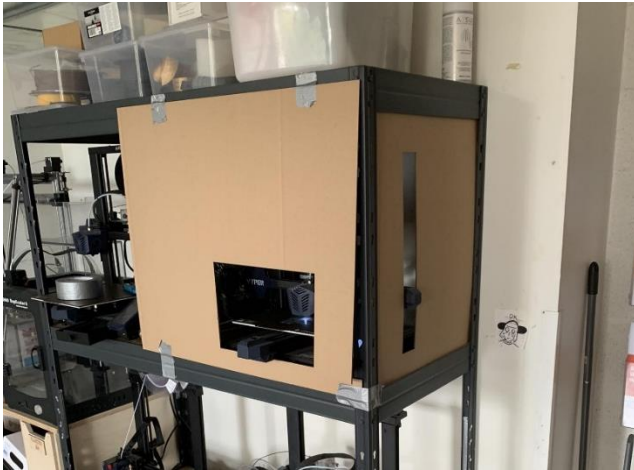
Pilt 3.1.3.5. FDM printeri kinni katmine (esimene kord). Autor Carl-Eric Uibo
