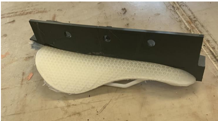
Pilt 3.1.5.4 Valmis sadul, üks vormipool eemaldatud. Autor Carl-Eric Uibo
