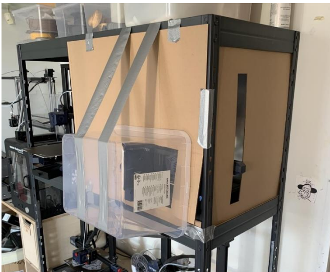
Pilt 3.1.3.6 FDM printeri kinnikatmine (teine kord). Autor Carl-Eric Uibo
