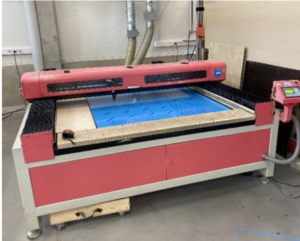
Foto 3.16 Laserlõikus Eccom OÜ tootmises. Autor A. Albert
