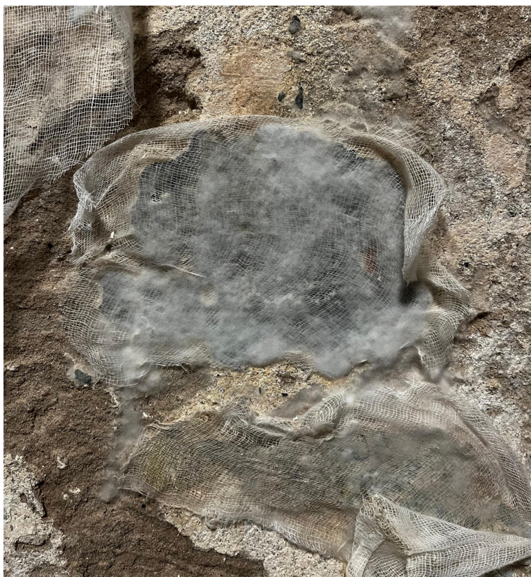
Joonis 4. Seinamaalingule jänesenahaga liimiga liimitud marli hallitab. Foto: erakogu.
