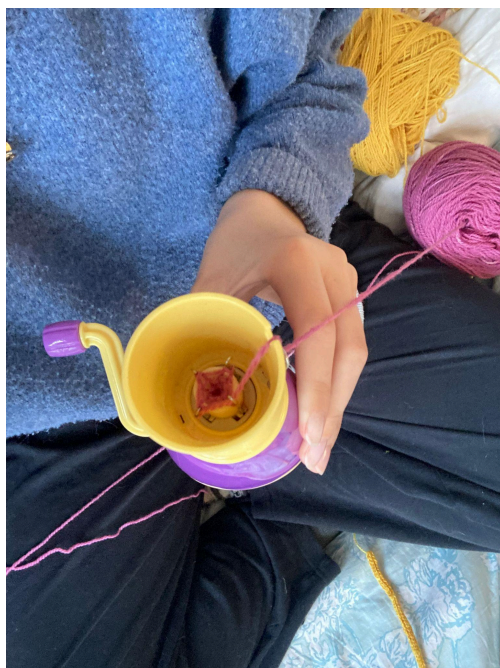
Foto 18. Mütsinööri kudumine nõõrimasinaga. Nõõrimasinat vändates koovad neli nõela ringset kudet, millest tekib nõõr
