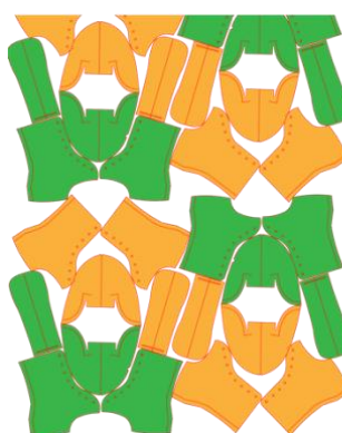
Joonis 27. Converse löike mustiline paigutus, vektorjoonis. Helen Strom
