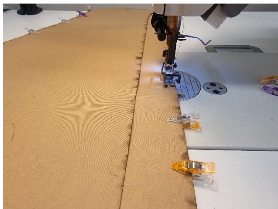
Joonis 9. Korktekstiilist lõigete kokkuõmblemine
