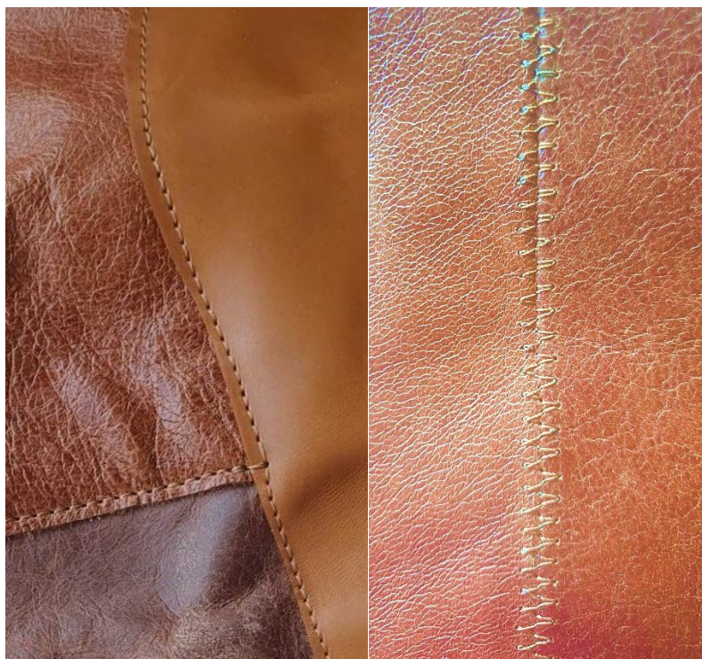
Foto 6. Ühendaamise võttete katsetused: servad üksteise peal ning läbi õmmeldud (pildil vasakul), paralleelselt kõrvuti asetatud nahatükid läbi õmmeldud sikk-sakiliselt (pildil paremal).
