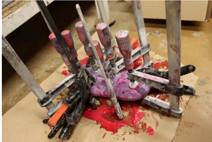
Foto 19. Tallavormis kuivav silikoon, millele lisatud punast värvipigmenti (autori foto)
