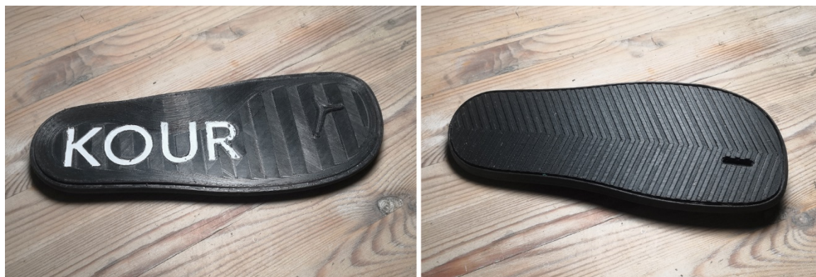
Foto 16. Väljaprint liimühendusega talla jaoks Primaselect Flex Black materjal (1,75 mm) (autori foto)
