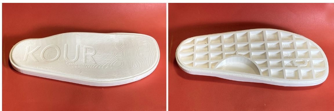
Foto 15. Esimene talla väljaprint Primaselect Flex ’iga (autori foto)
