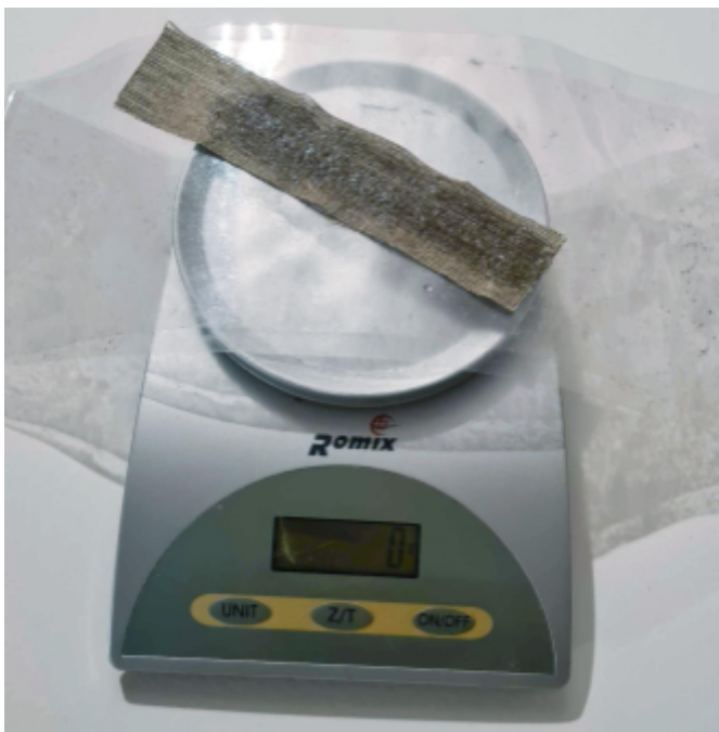
Pilt 7. Katseribale liimi kaalumisel pealekandmise meetodi katsetamine
