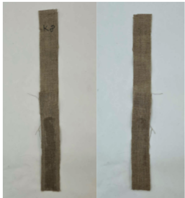
Pilt 6. Kalaliim+nisukliister katsekeha esi- ja tagakülg.
