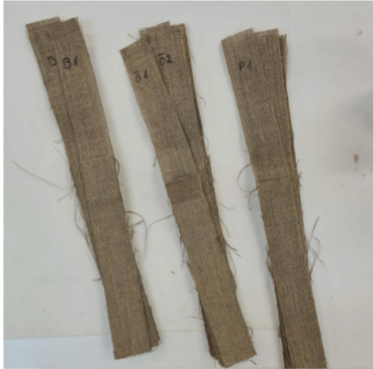
Pilt 5. Katsekehad: vasakult paremale paksem BEVA, õhem BEVA ja polüamiid
