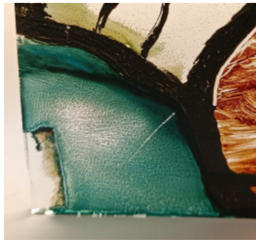
Foto 25. Rohelisel värvil mehaanilise kahjustuse näide
