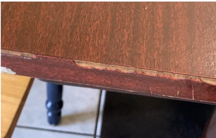
Joonis 1.8. Lauaplaadi servakandi kestendamine. Autori foto.
