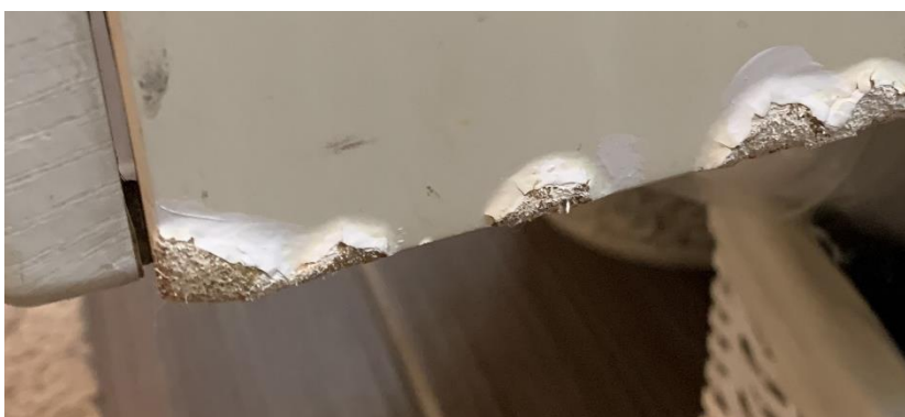
Joonis 1.6. Puitlaastplaadi niiskuskahjustus. Autori foto.
