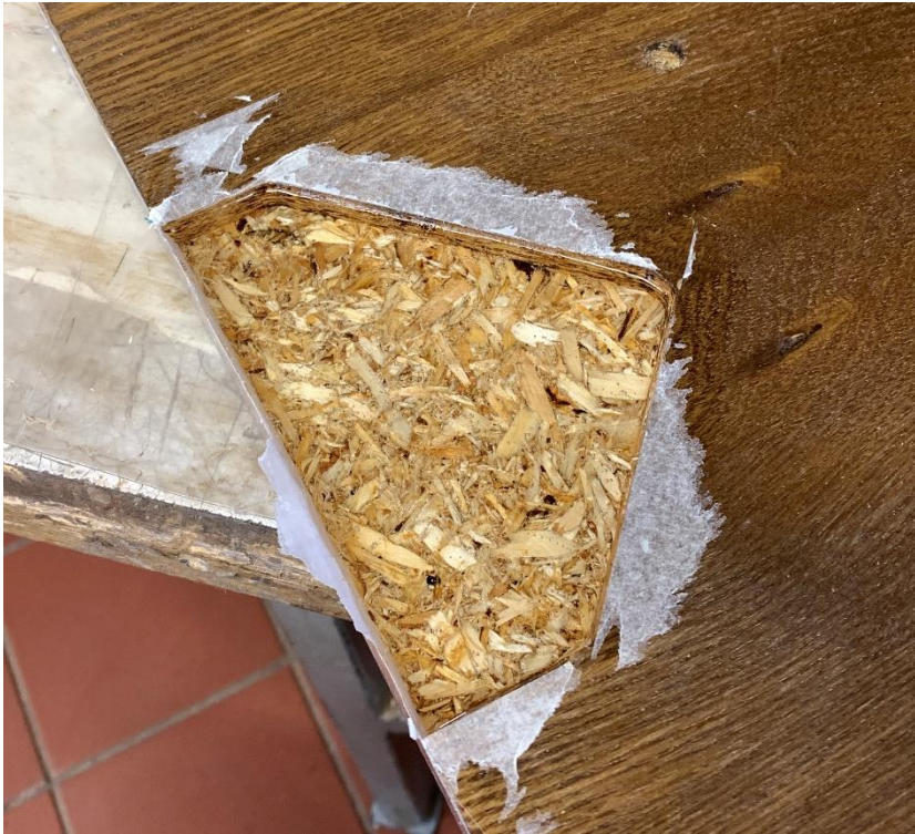
Joonis 3.11 Kahjustus nr 5 peale epoksiidvaigu valamist. Autori foto.
