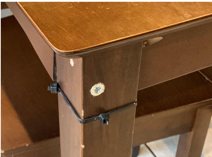
Joonis 1.7. Väsinud poltiaugud - nõrgenenud seotis. Autori foto.
