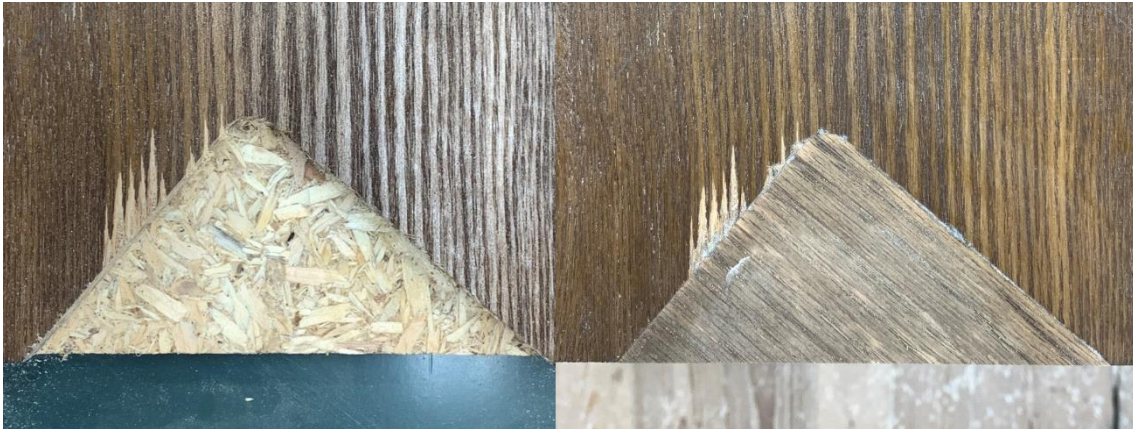
Joonis 3.5 Kahjustuse nr 2 enne ja pärast parandusmaterjali liimimist. Autori foto
