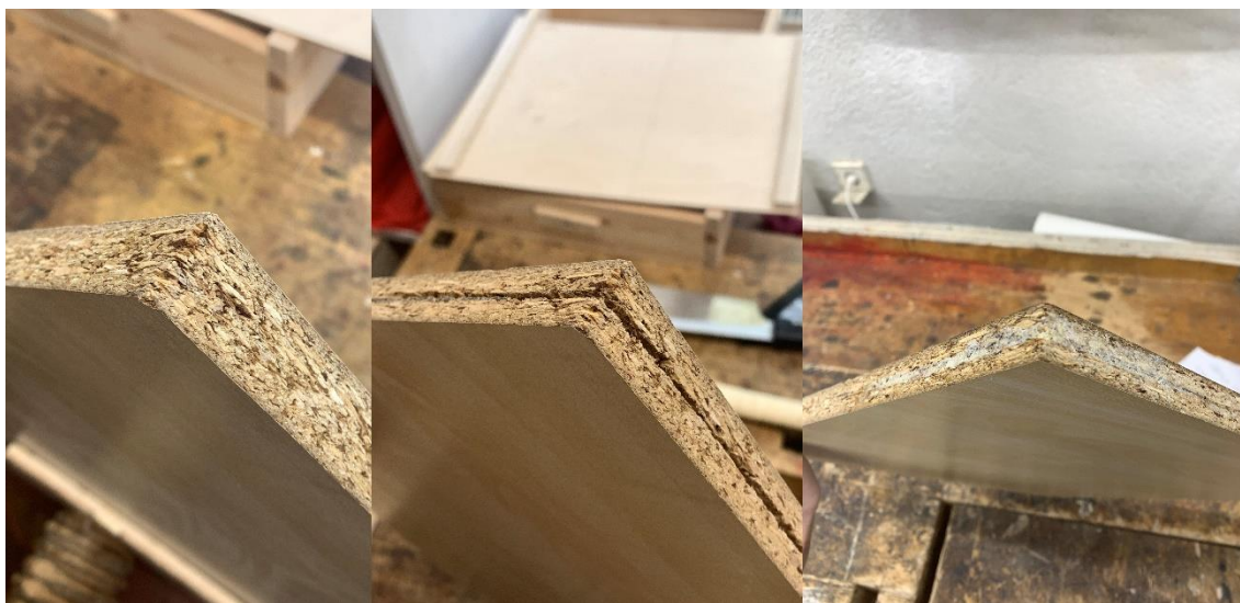
Joonis 3.15 PLP pundumine, sisse saetud lõhe ning materjal peale liimimist. Autori foto
