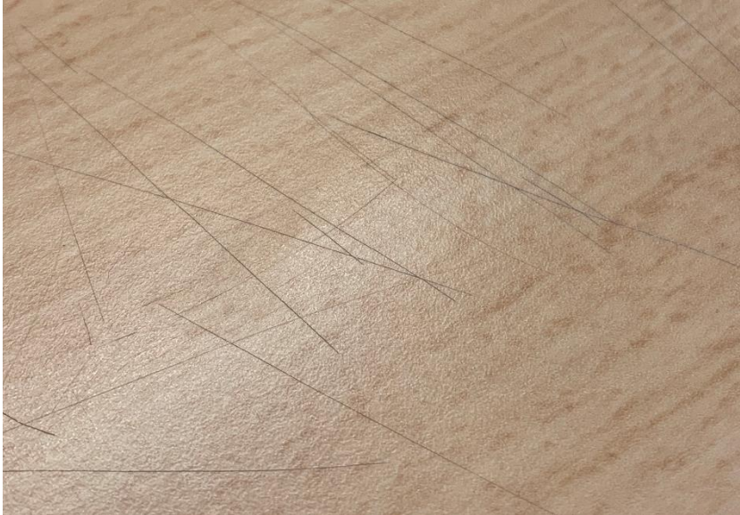
Joonis 1.9. Kriimustatud melamiinplaadi pealispind. Autori foto.
