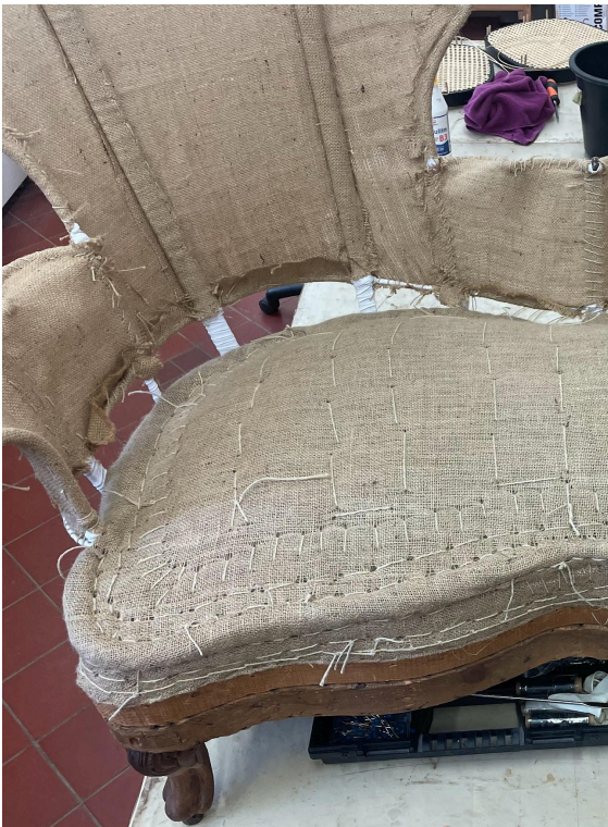
Foto 28. Istumisosa põhipolstri vormiõmblused
