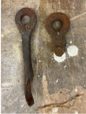
Foto 13. Murdunud kinnituste otsad
