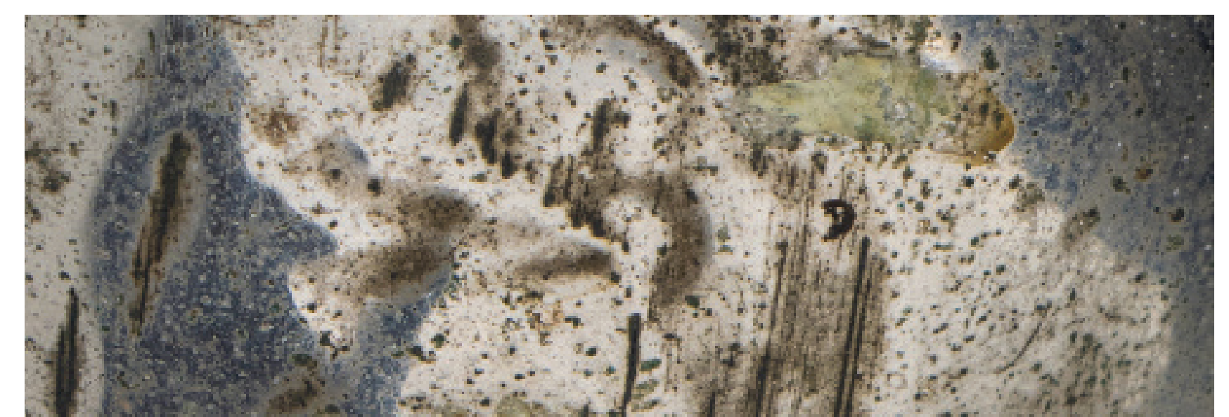
Mehaanilised kahjustused lambi kuplil
