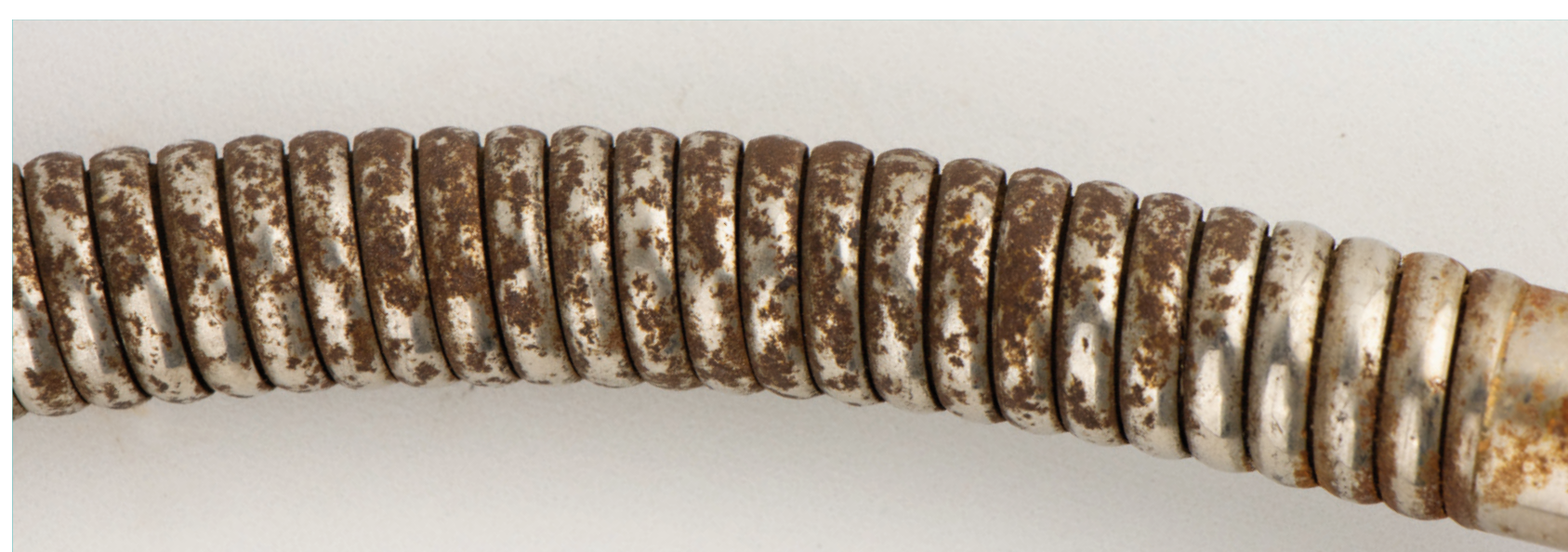
Oksüdatsioon lambi painduval varrel
