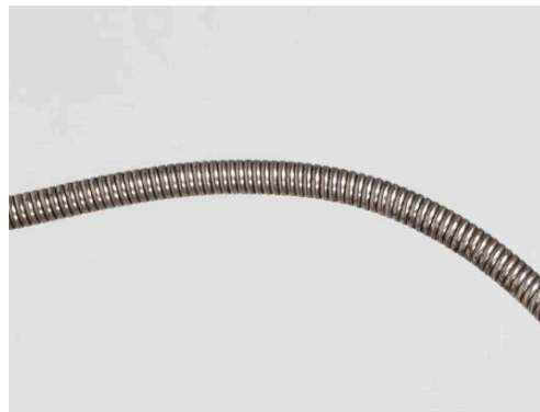
Joonis 7. Oksüdeerumine lambi painduval kaelal, foto M.-H. Lepna; Joonis 8. Lambi painutatav kael peale inhibeeriva vahendiga puhastust, foto K. Kasemets
