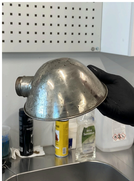
Joonis 10. Kupli esmane puhastus tiokarbamiidiga, eristatav on suuremast mustusest ja oksüdatsioonist puhastunud pind
