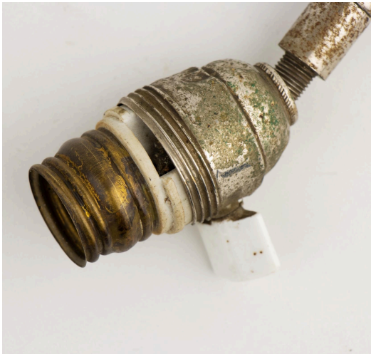
Joonis 5. Portselansokkel, pööratava lülitiga, nikeldatud mustusega kaetud soklitoosis, foto M.-H. Lepna; Joonis 6. Puhastatud portselan ja nikeldatud pind, foto K. Umal
