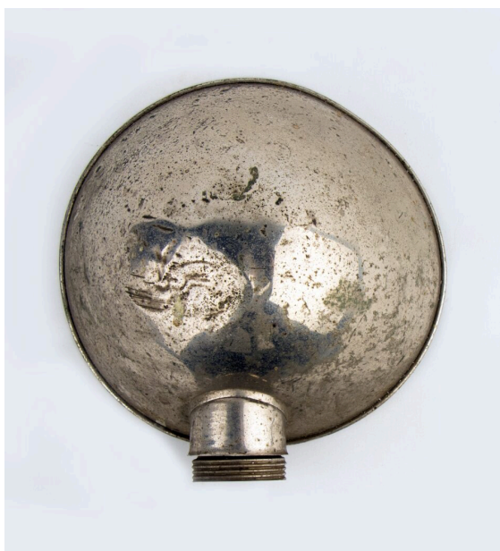
Joonis 3. Kuppel ja sel esinev oksüdatsioon, mehaanilised kahjustused enne puhastust, foto M.-H. Lepna;
