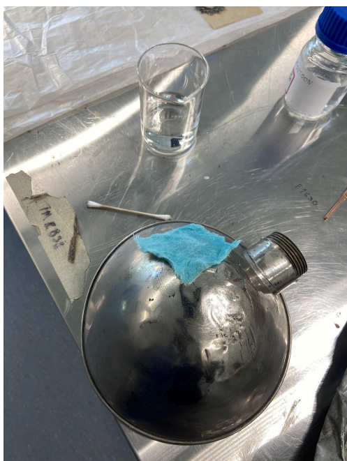
Joonis 11. Flitz pastaga puhastatud kuppel enne 8% fosforhappega töötlemist
