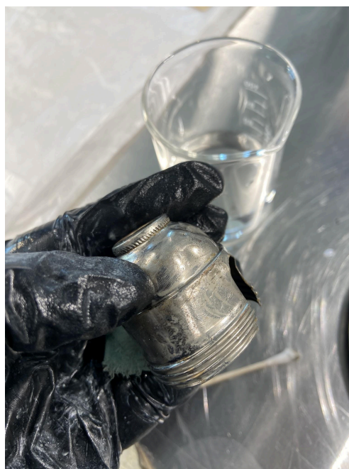
Joonis 12. Kuna pinnal esinev mustus ja oksüdatsioon reageeris kõige paremini fosforhappega, kasutasin sokliitoosi puhastamiseks ainult fosforhapet
