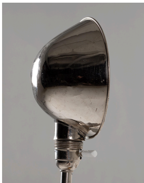
Joonis 3. Kuppel ja sel esinev oksüdatsioon, mehaanilised kahjustused enne puhastust, foto M.-H. Lepna;
