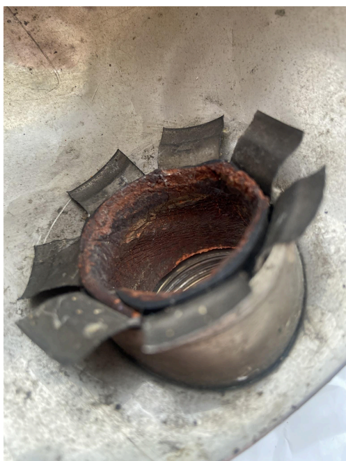
Joonis 3. Lagunev isolaator materjal, lähemalt näha lambikupli oksüdeerunud metallpind
