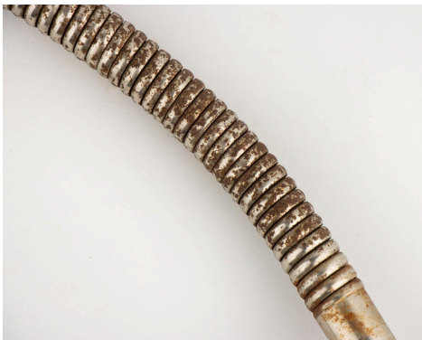
Joonis 7. Oksüdeerumine lambi painduval kaelal, foto M.-H. Lepna; Joonis 8. Lambi painutatav kael peale inhibeeriva vahendiga puhastust, foto K. Kasemets
