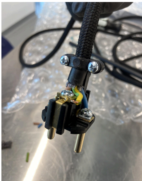
Joonis 9. Uus pistik, nähtav on termorüüs kaablijuhtude hargnemise takistamiseks
