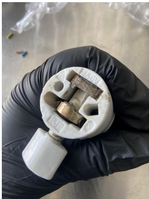
Joonis 2. Ultraheliga puhastatud sokkel, nähtaval tootjapoolsed tähised, asendatud klemm
