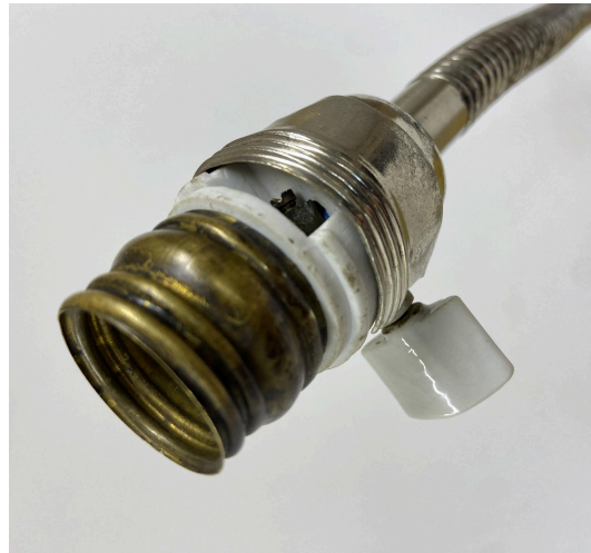
Joonis 5. Portselansokkel, pööratava lülitiga, nikeldatud mustusega kaetud soklitoosis, foto M.-H. Lepna; Joonis 6. Puhastatud portselan ja nikeldatud pind, foto K. Umal
