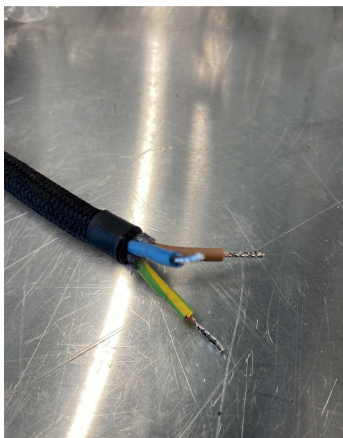
Joonis 8. Joodetud juhtmeotsad, juhtmele lisatud termokahanev rüüs välistab kangasjuhtme hargnemise
