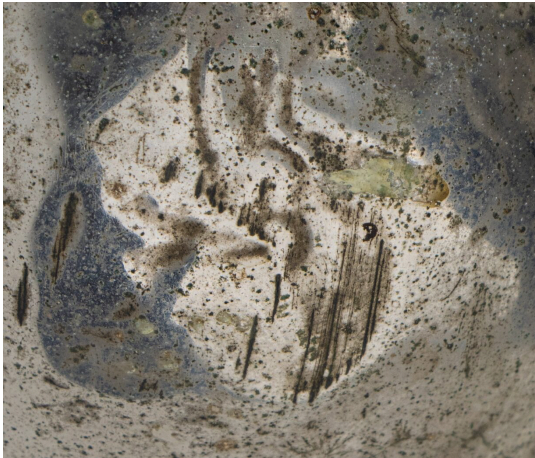
Joonis 11. Kuplil esinevad mehaanilised kahjustused ja oksüdatsioon, foto M.-H. Lepna; Joonis 12. Kuppel pärast puhastust, foto K. Kasemets
