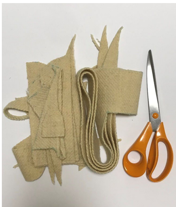
Joonis 22 Juurdelõikusjääki jäi järele vaid väga väikeste tükkidena. Jägist saab lõigata vöötripid ja väiksemad lisadetailid.
