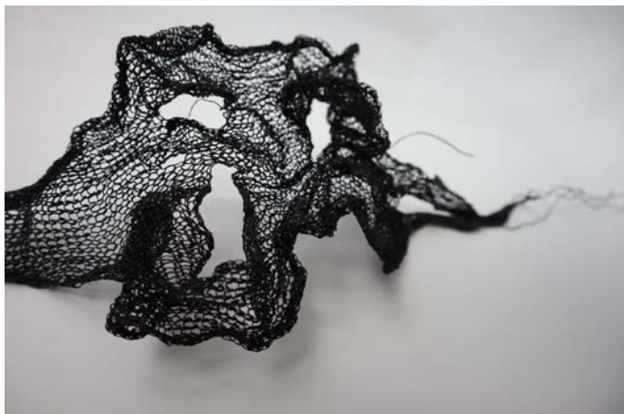
Foto 12. Želatiini abil kõvastatud linane proov. Avaused tekitatud osalise kudumise abil
