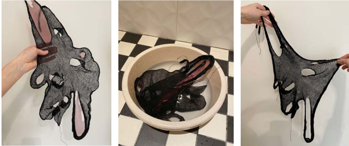
Foto 15. Fotodel on näha vormi ja bioplasti kadumist vee abil
