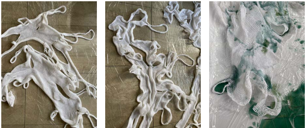
Foto 27. Vasakul: algses olekus pehmed kudumid. Keskel: samad kudumid želatiini abil vormituna ja kuivavana. Paremalt: kanga värvimine bioplasti abil
