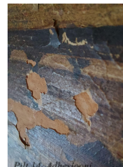
Pilt 14. Adhesiooni kaotanud maalipind
