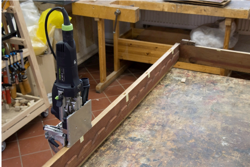
Foto 10. Domino lamellide jaoks pesade tegemine.
