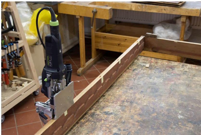
Foto 10. Domino lamellide jaoks pesade tegemine.
