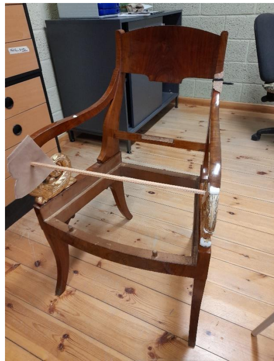
Foto 10. Käetoe paigaldamine tooli konstruktsiooni. Autori foto
