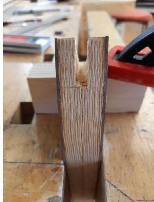
Foto 8. Tapipesa käetoe ühendamiseks puidulõikega. Autori foto
