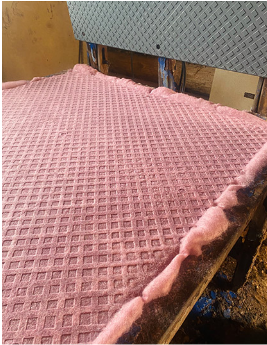
Foto 29. Hallimäe talu plaatviltimismasinal tehtud eelvildid. Vasakul on äsja valminud eelvilt plaatviltimismasinal, paremal nõrguvad eelvilditahvlid.
