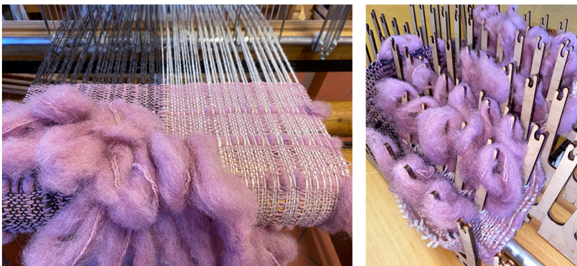
Foto 16. Katse 4. Kudumine kangastelgedel pärilpõime tehnikas, kontrollitud kohtades koeaasad. Parempoolsel pildil on MW lõimetoekamm lükatud läbi kanga aasu toestama.
