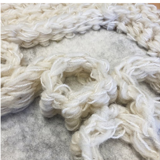
Foto 14. Katse 2. Parempoolsel pildil on näha alusvildi vanumine tumedamaks kui multiveevitud struktuur.
