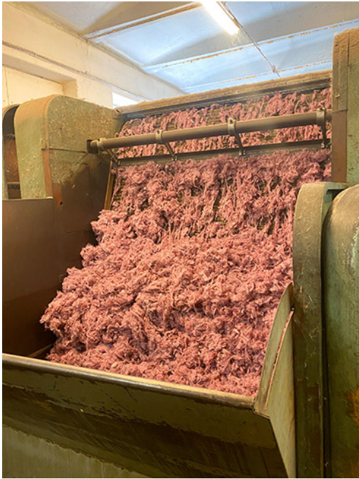
Foto 28. Raasiku villavabrik. Vasakul: värvitud vill kraasimismasinas, paremal: valmis kraasvill.
