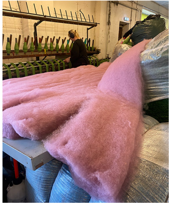
Foto 28. Raasiku villavabrik. Vasakul: värvitud vill kraasimismasinas, paremal: valmis kraasvill.
