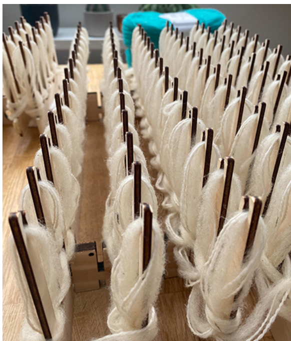
Foto 22a, 22b. Katse 8 tööprotsess. 22a: lõimetoekammidele veetud lõimeread. 22b: Toestatud lõimetugede lükkamine läbi villakihi.
