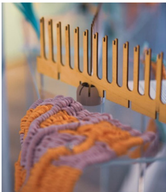
Foto 6a, 6b. 6a: 3D-prinditud poolkera-kujuline alus kammidele, 6b: painutatavad pikendused lõimetoele. Fotod: Lisette Laanoja.
