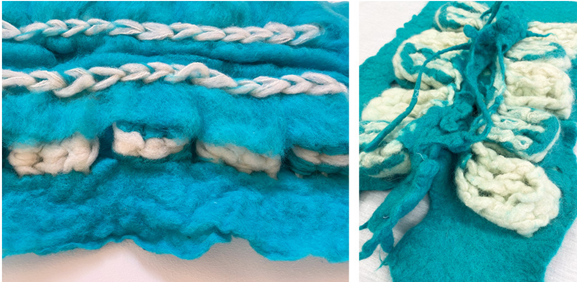
Foto 24a, 24b. Katse 8.2. 24a: õhukese villakihi lisamine juba vanutatud proovile. 24b: detail pärast vanust.
