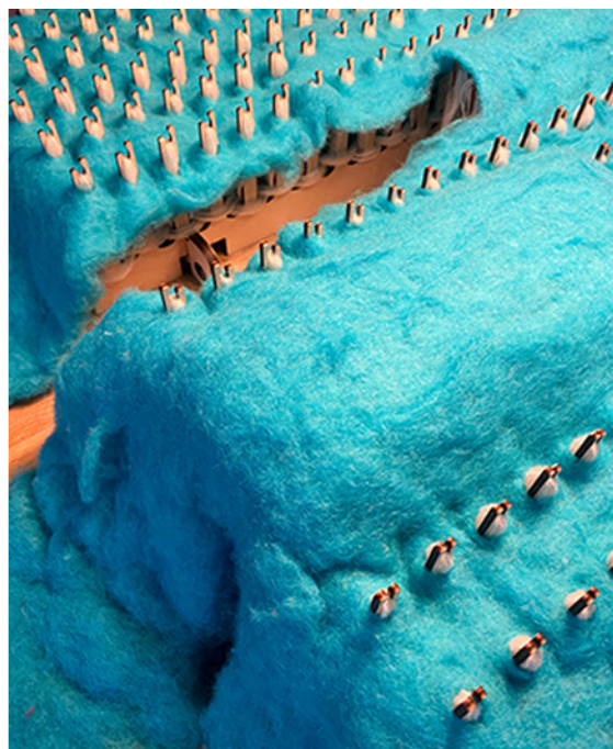
Foto 22a, 22b. Katse 8 tööprotsess. 22a: lõimetoekammidele veetud lõimeread. 22b: Toestatud lõimetugede lükkamine läbi villakihi.
