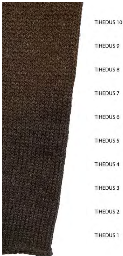
Foto 27. Tööproov kahandamisest silmuskudumismasina koetiheduse muutmise teel. Katse 6.
