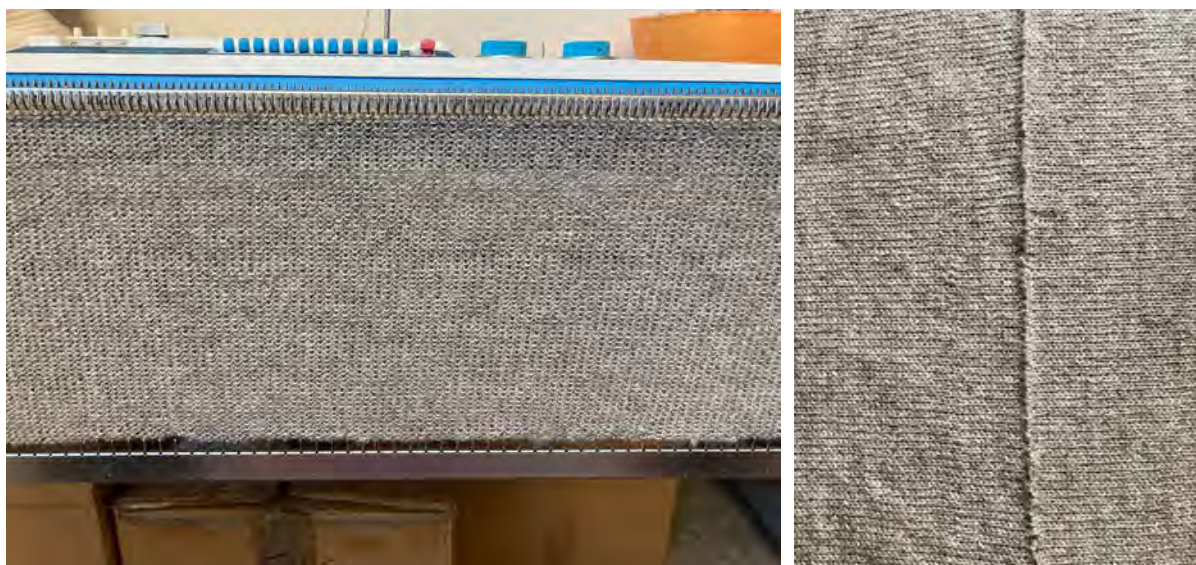
Foto 22. Tööproov kudumismasinal pika riba saamiseks ja valmis kangas, kus ribad on ühendatud. Katse 1.
