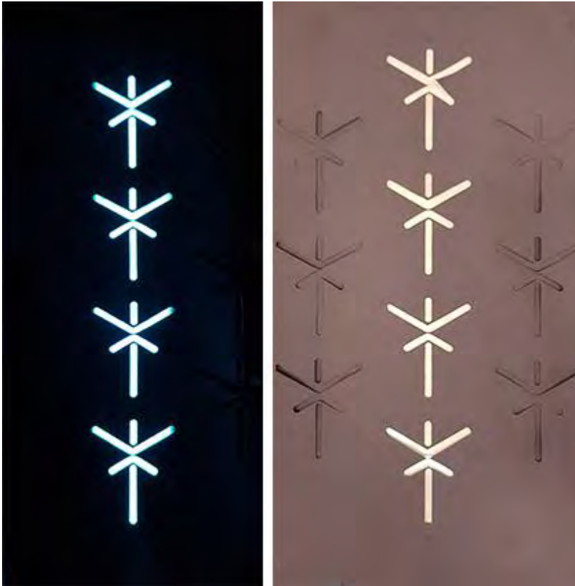
Foto nr 18. Katse nr 4. Suuremate avadega laserlõikusega pind. Vasakul helendav paneel ja paremal fotol kustunud olekus paneel
