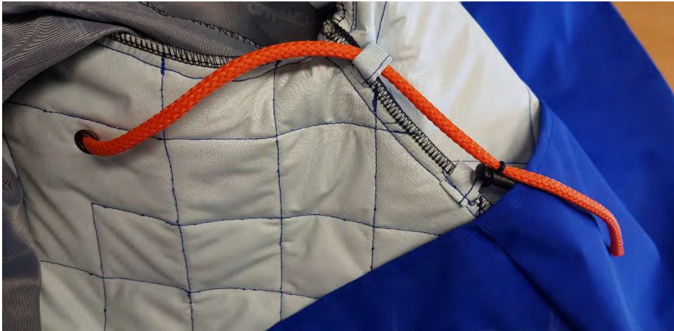
Foto nr 22. EL traadi jooksu kinnitamine.
