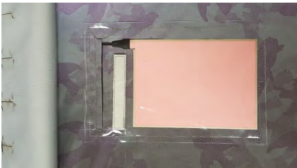
Foto nr 14. Katse nr 4. Taustakangale paigaldatud EL paneel.
