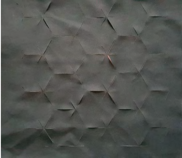
Foto nr 15. Katse nr 4. Laserlõikusega proovitükk ilma valgustusega.
