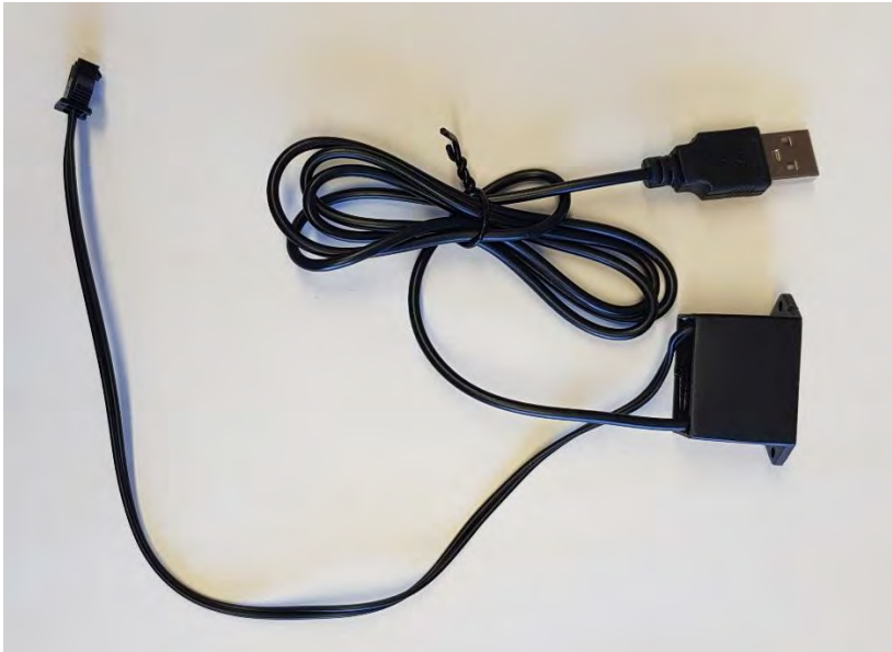
Foto nr 3. Valgusallikate toitejuhe koos inverteriga.
