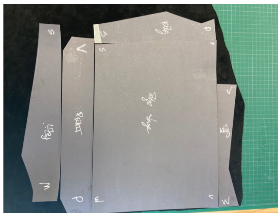
Foto 32. Arvutikoti lõigete paigutamine nahale
