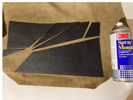
Foto 34. Naha dubleerimine laustnahaga 3M Spray Mount liimi kasutades.
