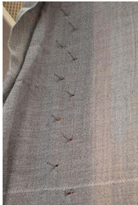
Foto nr. 35. Aluskanga kinnitamine raamile. Foto nr. 36. Naelad aluskanga kinnitamiseks.
