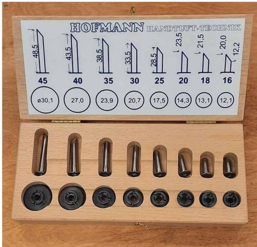
Foto nr. 23. Käsitaftingpüstoli nõelad ja toiterattad.
