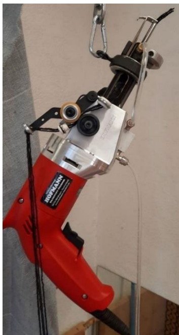
Foto nr. 21. Pallase tekstiiliosakonnas kasutatav käsitaftingpüstol VML 16 -Ø6-18mm.
