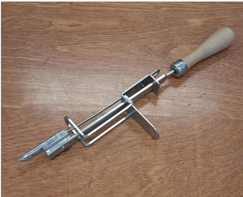
Foto nr. 7. Mehaaniline töövahend käsitaftingvaipade valmistamiseks.
