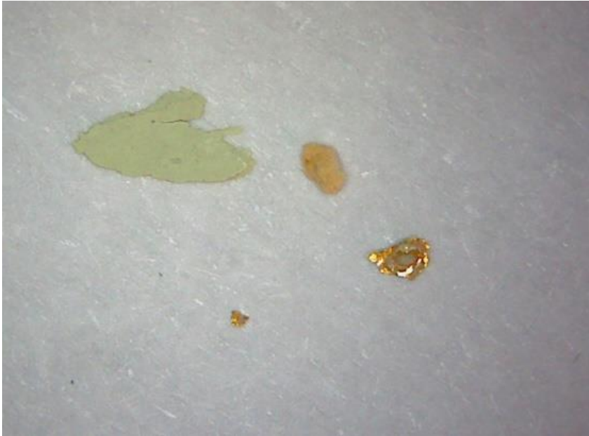
Foto D. Kullajäägid raamistuselt. Mikroskoobifoto.
