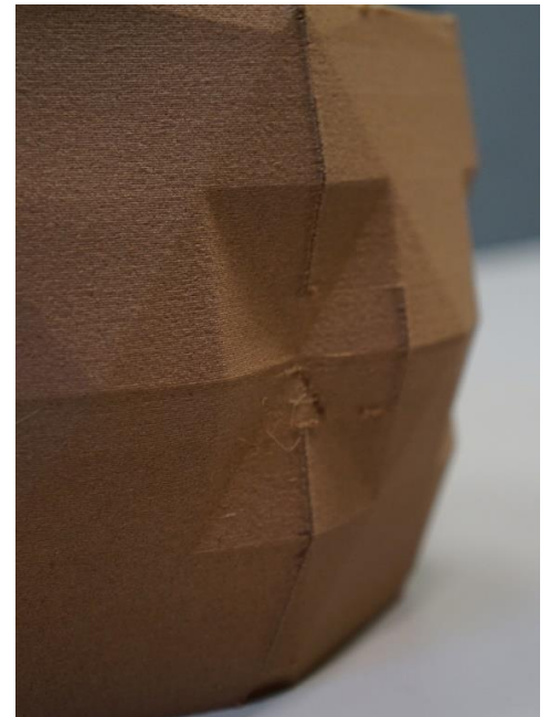
Foto 32. Printeripea tagasipööramisest tekkinud defekt
