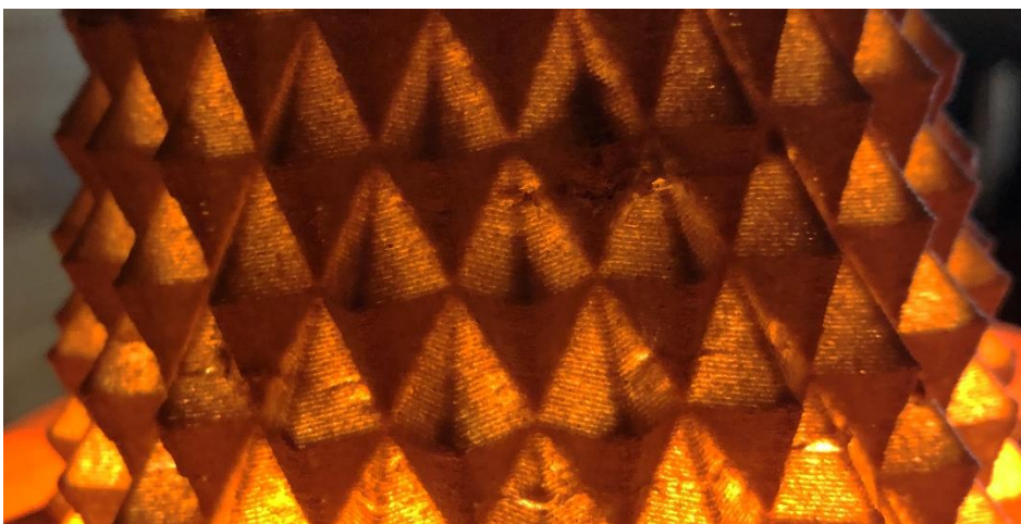
Foto 39. Defektid, mida on valgusega näha.
