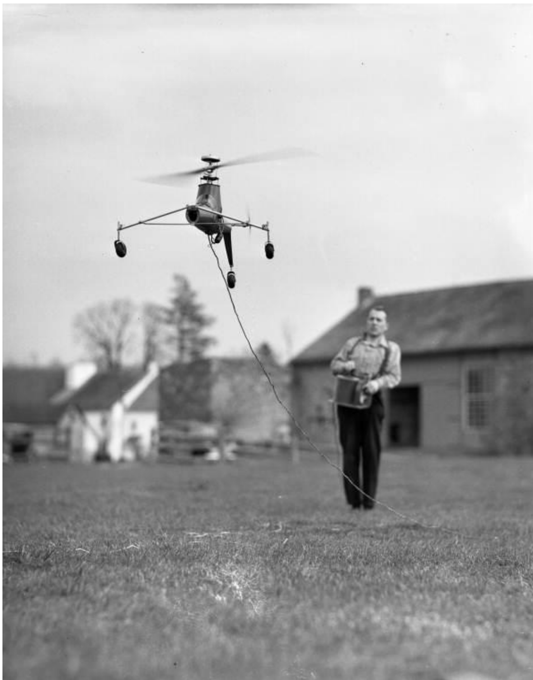
Lisa 3. Arthur M. esimene raadio teel juhitud helikopter aastal 1941
