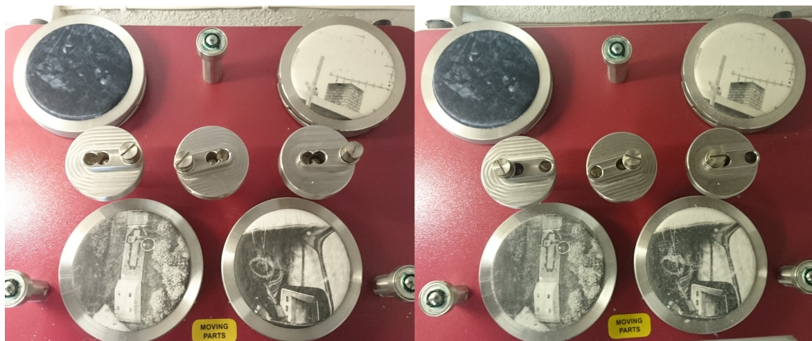
Pillingutest. Vasakul on pilt enne testimist ja paremal pärast. Autori fotod.
