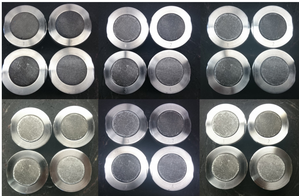
Hõõrdekindlusetest. Pilt on tehtud peale igat 5000 pööret. Autori fotod.
