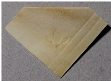
Pärgamendi painutamine ja pimetrükk – niisutatud veega, 70% etanooliga ja 80% isopropanooliga.
