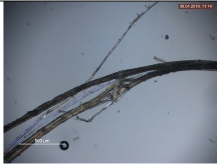
Õmblusniidikiu määramine mikroskoobis s=100x tavalises valguses. Tuvastati lina kiud (Foto Kurmo Konsa)
