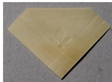
Pärgamendi painutamine ja pimetrükk – niisutatud veega, 70% etanooliga ja 80% isopropanooliga.
