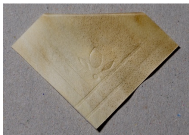
Pärgamendi painutamine ja pimetrükk – niisutatud veega, 70% etanooliga ja 80% isopropanooliga.
