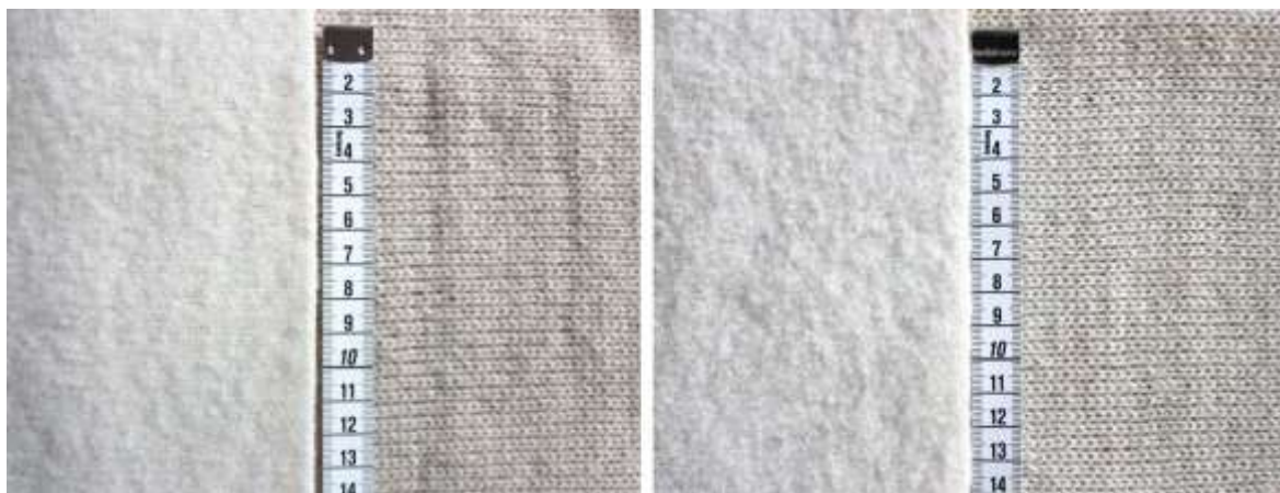
Joonis 12. Vanutatud ja vanutamata kangaste struktuurierinevus. Vasakul Muhus kasvanud maalamba villast kedratud kraaslõngast kootud kangad, paremal Kihnu maalamba villast kedratud poolkammlõngast kootud kangad.
