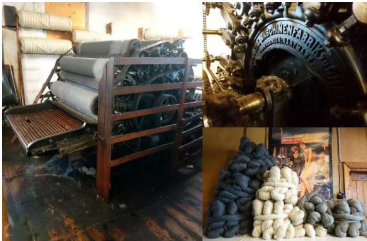
Joonis 5. Äksi villavabrik. Vasakul heidemasin, paremal üleval lähifoto sajandivanuse kraasimismasina mehhanismist, paremal all valik naturaalvalgeid ja värvitud villast kedratud lõngu Äksi villavabriku poes.
