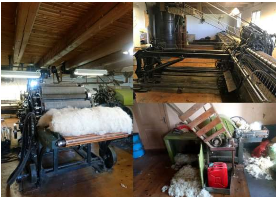
Joonis 6. Kabala villaveski. Vasakul kraasimismasin, paremal üleval poolautomaatne ketrusmasin, paremal all villahunt.
