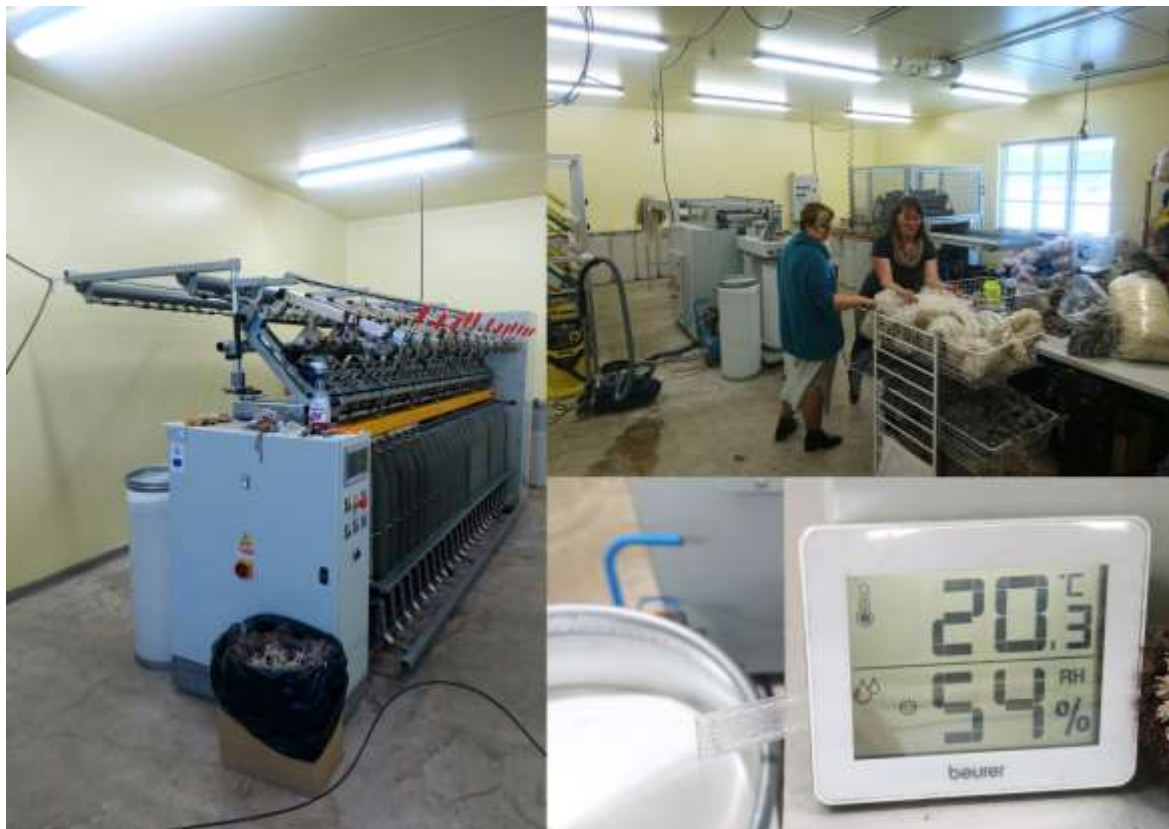
Joonis 10. Muru villavabriku kaasaegsed poolkammlõngu valmistavad masinad. Vasakul ketrusmasin, paremal üleval Liina Kool ja Liina Lehis villadega tutvumas, paremal all hügrokoop õhuniiskuse ja temperatuuri mõõtmiseks.
