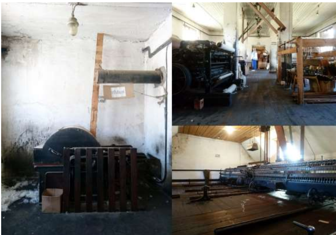
Joonis 7. Süvahavva villavabrik. Vasakul villahunt, paremal üleval Süvahavva villavabriku siseruum, paremal all poolautomaatne ketrusmasin.
