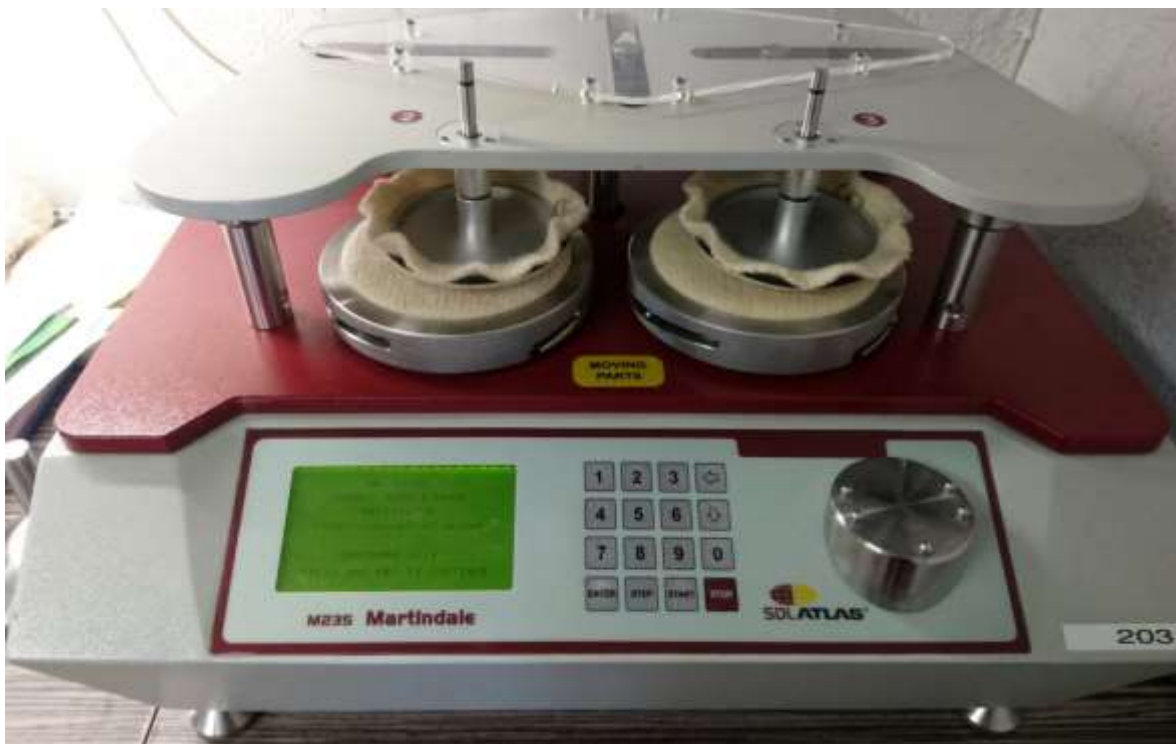
Joonis 14. Tekstiilitestimise seade Martindale. Pillingutest neljale villasele kangale.
