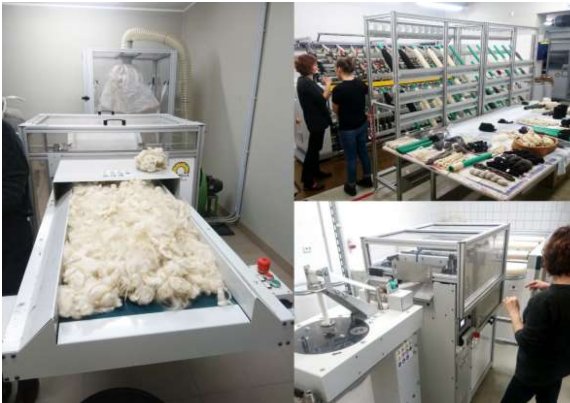
Joonis 9. TÕ VKA Vilma villakoda. Vasakul kaasaegne villahunt, paremal üleval ketrus- ja korrutusmasinad, paremal all draftimismasin.
