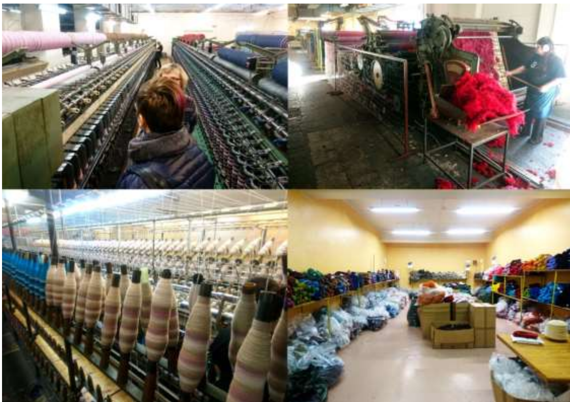
Joonis 4. Raasiku villavabrik. Üleval vasakul ketrusmasin, paremal kraasimismasin, all vasakul korrutusmasin, paremal Raasiku villavabriku lõngapood.
