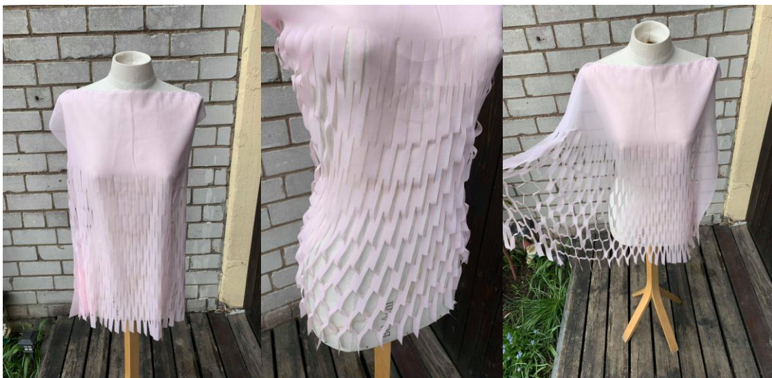
Pilt 21: Laserlõike tehnoloogia katsetused sünteetilise kangaga Fotod: Kristin Mällo
