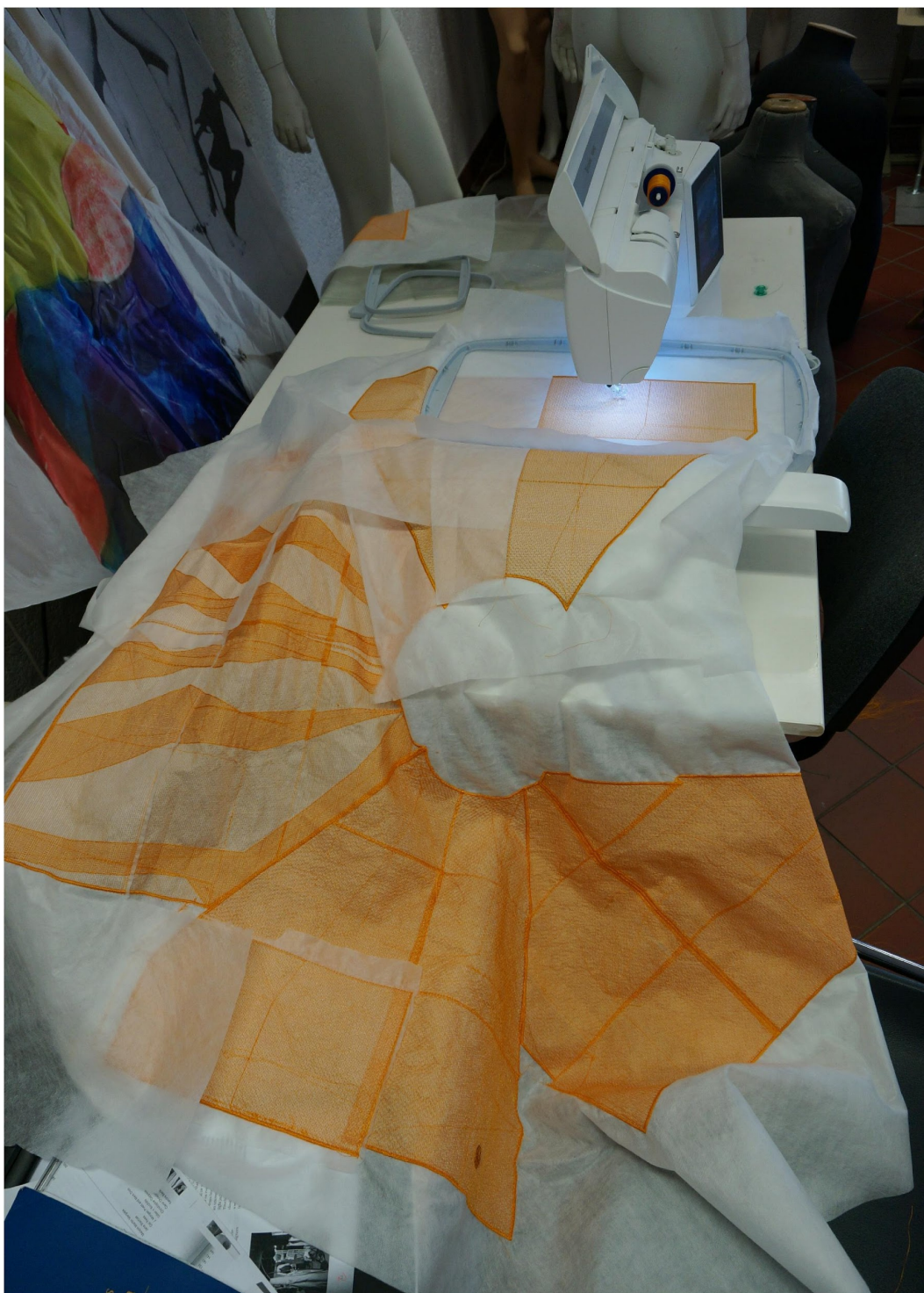
Foto 2. Katse 26. Raami limber paigutades loodud pind. Proov on teostatud polilesterniidiga ja vees lahustuvale tugikangale. Tulemus on jaadvustatud tikkimis protsessi ajal. Autori foto
