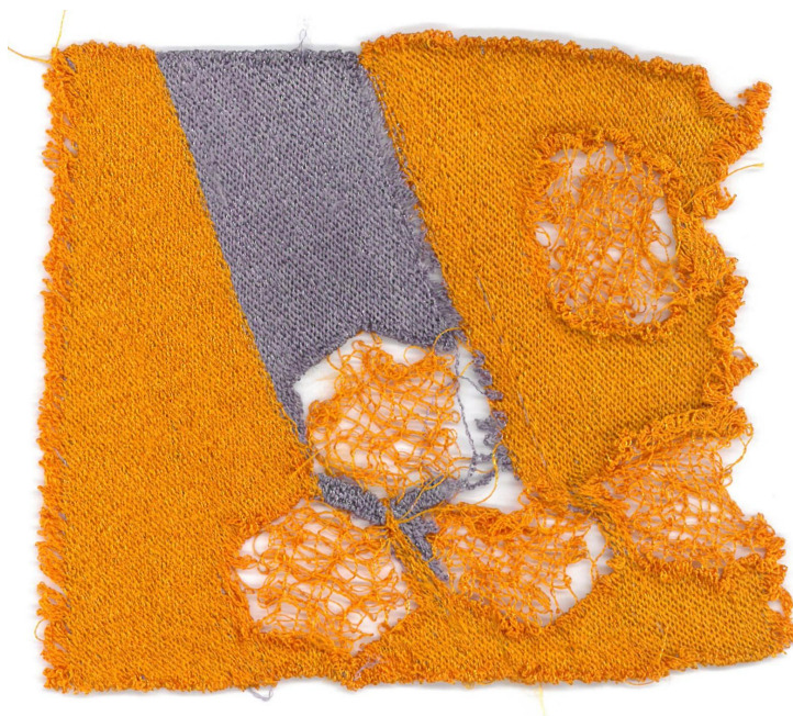
Katse 9. Erinevate tihedustega mustri näide. Proov teostatud viskoos (lilla) ning polüesterniidiga vees lahustuvale kilele. Tulemus on jäädvustatud pärast tugikanga välja sulatamist. Autori foto
