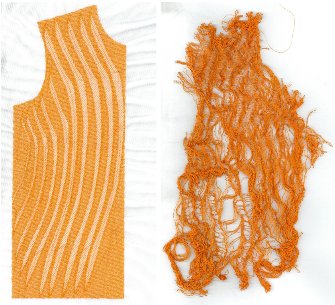
Katse 13. Ilma aluskihita näide. Proov on teostatud polüesterniidiga ja vees lahustuvale tugikangale. Tulemus on jäädvustatud enne ja pärast tugikanga välja sulatamist. Autori foto
