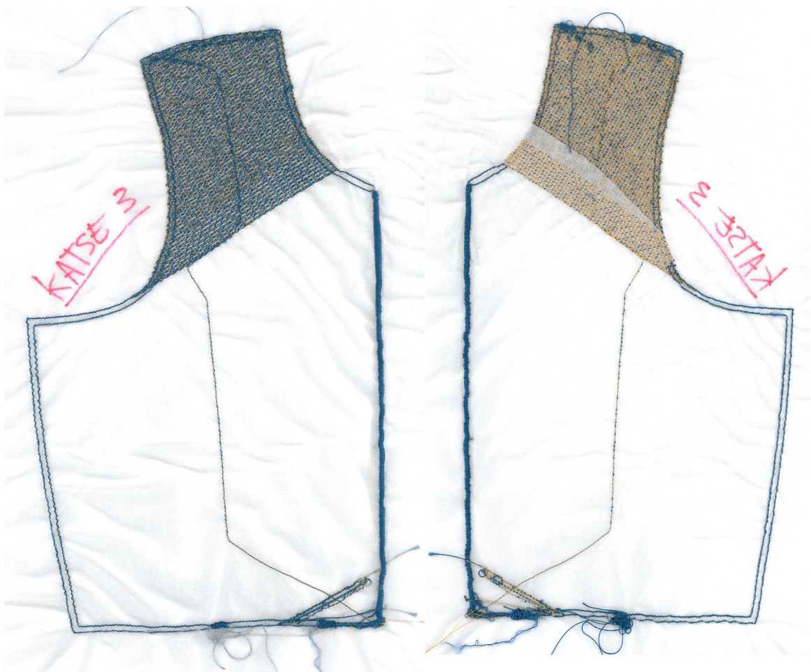
Katse 8. Esiosa lõike näide pealt ja alt. Proov teostatud peenema polüesterniidiga ja jämedama polüesterniidiga vees lahustuva tugikangale. Autori foto
