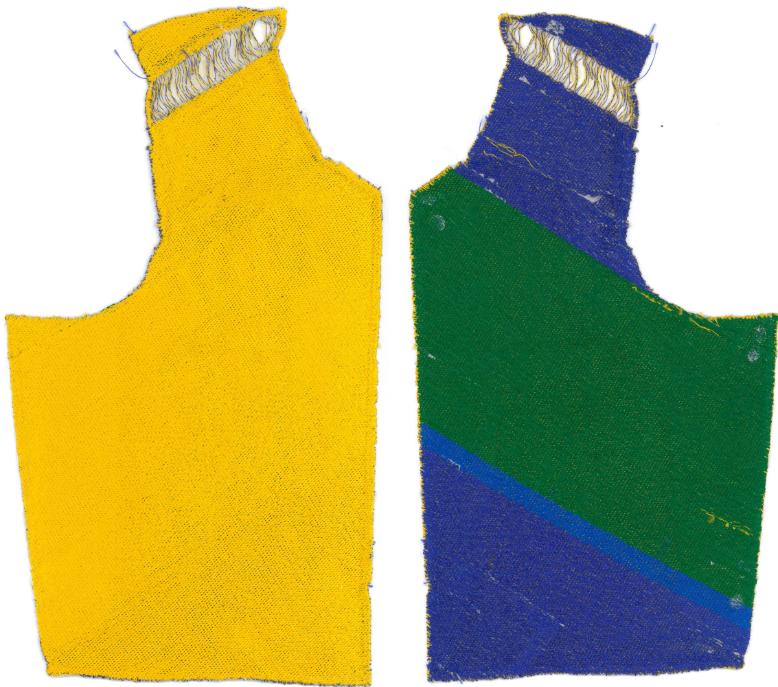
Katsetus 1. Esiosa löike näidis pealt ja alt. Proov teostatud ärarebitavale tugikangale ja polüesterniidiga. Tulemus on jäädvustatud pärast tugikanga eemaldamist. Autori foto
