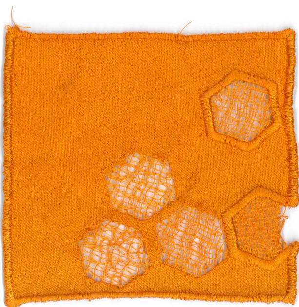
Katse 10. Erinevate tihedustega muster kohandatud versioon Katse 9-st. Proov on teistatud polüesterniidiga ja vees lahustuvale kilele. Tulemus on jäädvustatud pärast tugikanga välja sulatamist. Autori foto
