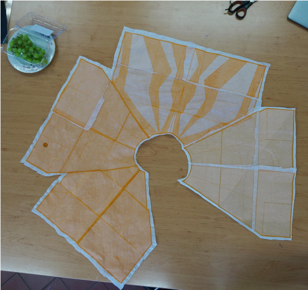
Foto 1. Katse 26. Raami ümber paigutades loodud pind. Proov on teostatud polüesterniidiga ja vees lahustuvale tugikangale. Tulemus on jäädvustatud enne tugikanga välja sulatamist. Autori foto
