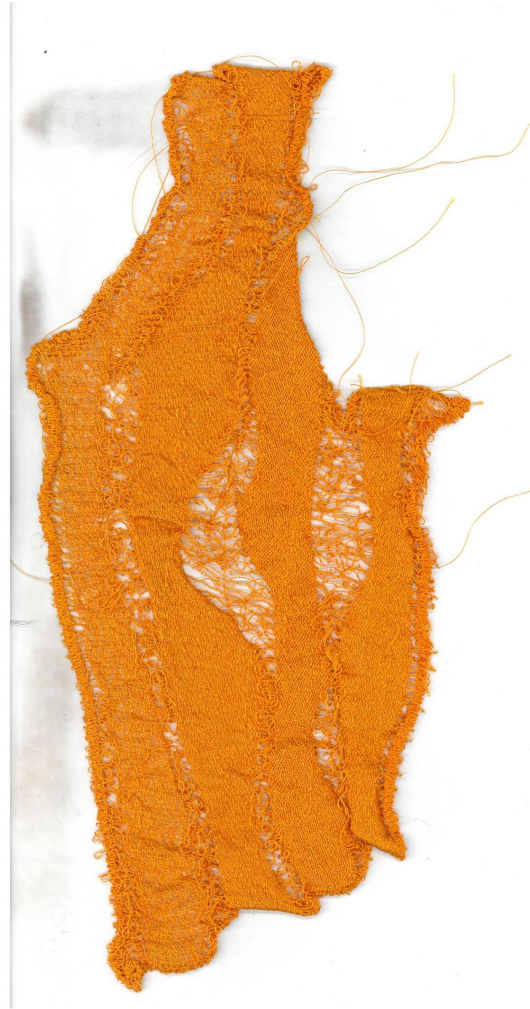
Katse 12. Erinevate tihedustega osade näidis. Proov on teostatud polüesterniidiga ja vees lahustuva tugikangale. Tulemus on jäädvustatud enne ja pärast tugikanga välja sulatamist. Autori foto
