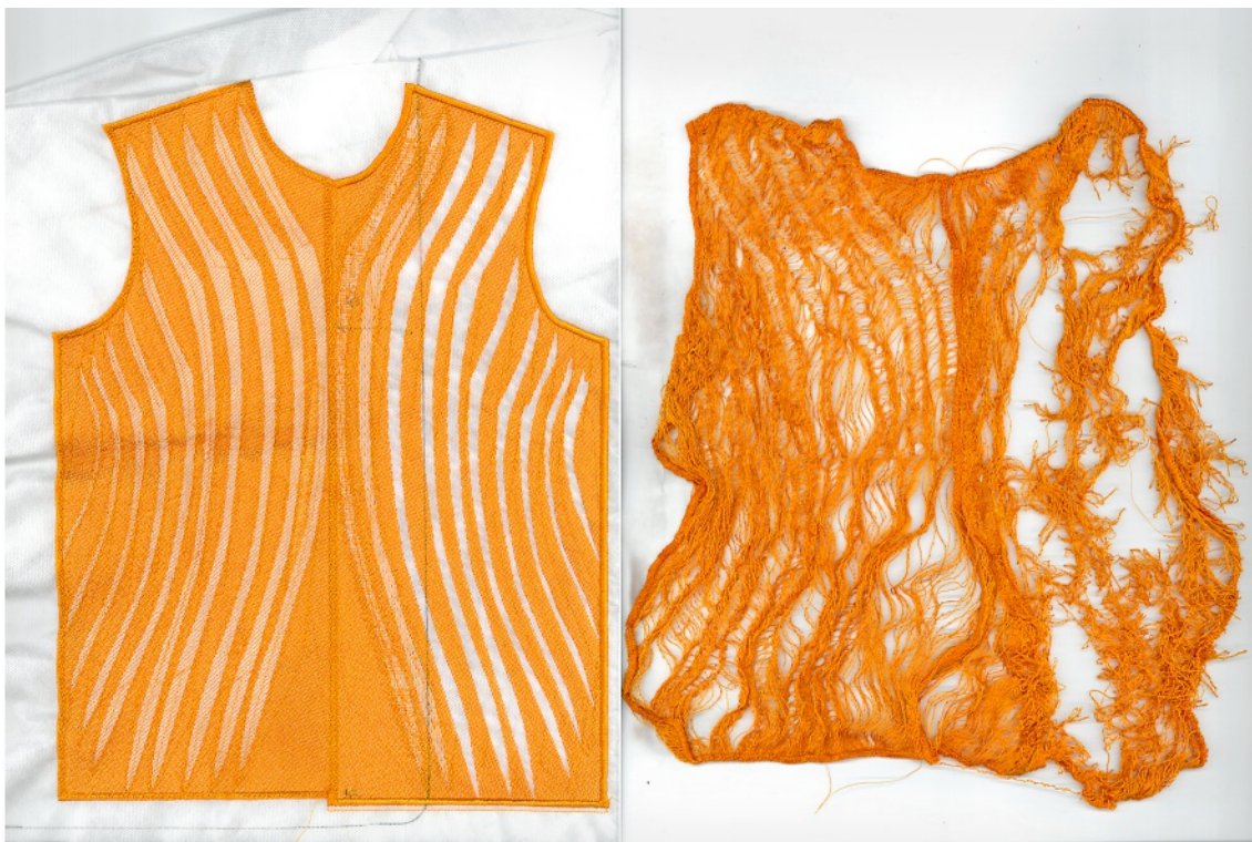
Katse 9. Rõiva esiosa enne ja pärast aluskanga väljapesemist. Experiment N o 9. Front of the garment before and after washing out the underlay.
