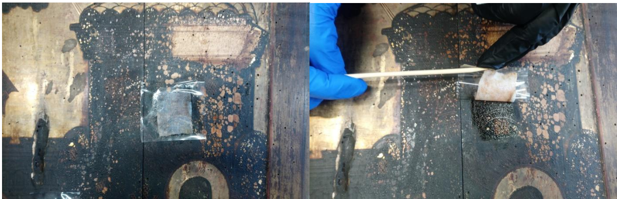
23 ja 24. 3% Klucel G-ga geelistatud etanool ja 10% triammooniumvesilahuse segu pealekantuna geelkompressi meetodil. Fotol näha puhastusproov üsna kahjustatud kohal. (Foto: Kristel-Kai Kooskora)
